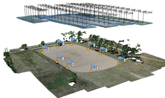
Figura 4 - Geração de nuvem densa de pontos da superfície V.
