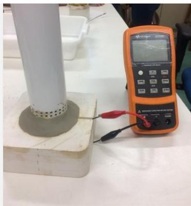
**Figura 10** Sensor capacitivo cilíndrico para determinação da propriedade dielétrica das sementes.
