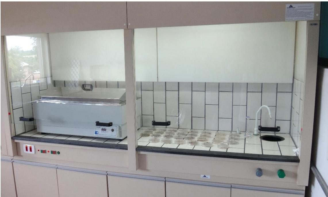
Figura 5. Capela com exaustão de gases para manuseio das amostras.
