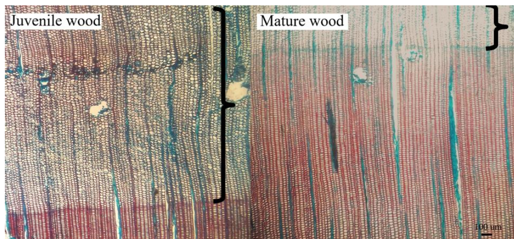
Figura 6: Imagem microscópica no plano transversal de uma madeira de Pinus elliottii . Fonte Autor (2020).
