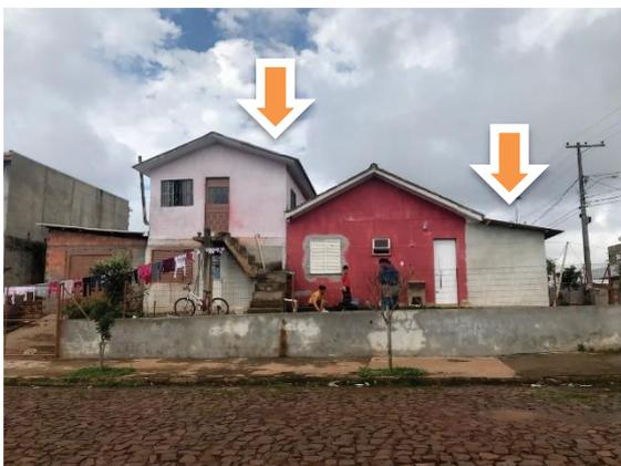
Figura 5.22: Ampliação realizada pelo morador do Conjunto Amanhecer II, criação de 2º pavimento, ampliação para os fundos e para frente. Fonte: Autora, 2019.
