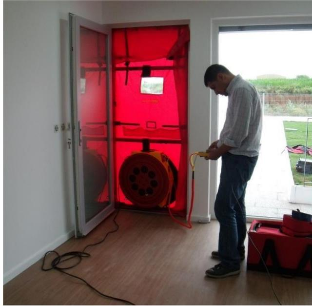
Figura 4: Execução do *blower door test* em uma *Passive House* em Aveiro-PT
