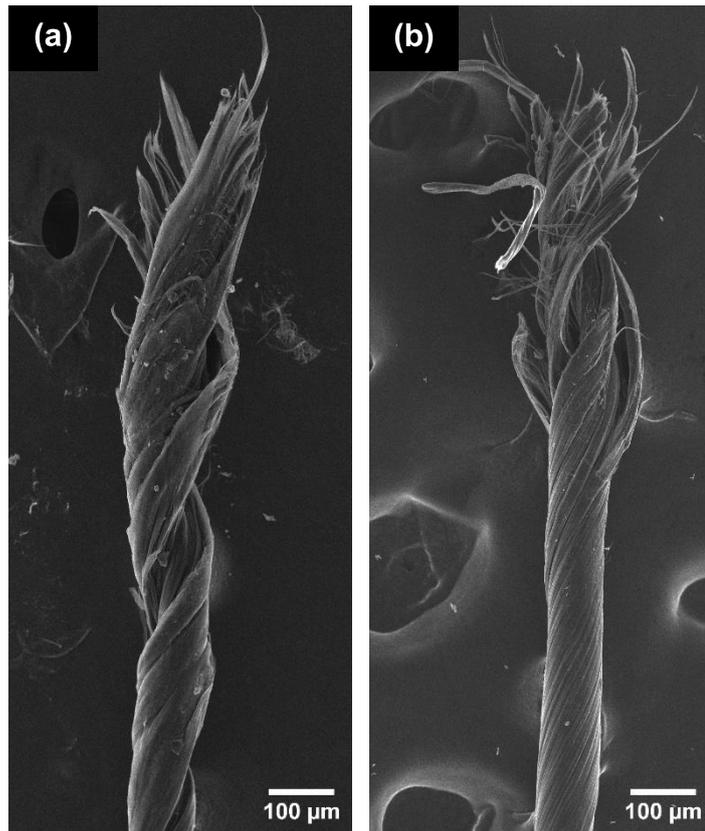
Figura 20 - (a) Falha do CNTY com carga de 70% do YBL e temperatura de 25°C; (b) Falha do CNTY com carga de 70% do YBL e temperatura de 50°C. (Fonte: Autor)
