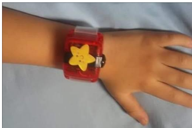
Figura 3 - Posição correta do acelerômetro para fixação ao pulso.
