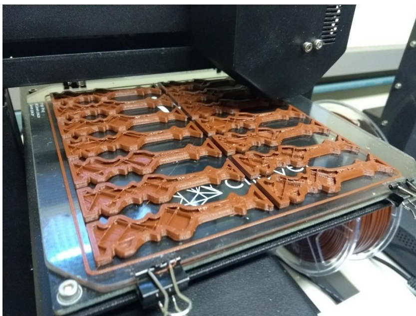
Figura 64: Balaústres sendo impressos em 3D
