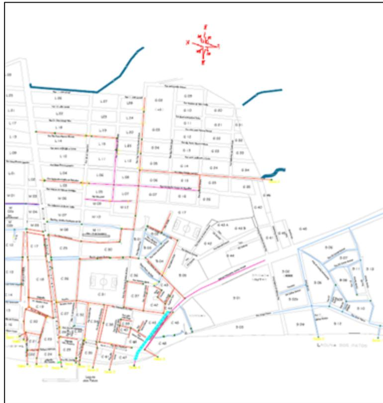
Figura 2 – Mapa do Sistema de Esgoto Pluvial da Zona Sul de São José do Norte.
