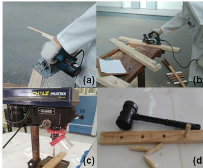
Figura 2: etapas de usinagem; (a) corte com serra circular; (b) aplainamento; (c) furação; (d) montagem das peças.
