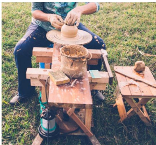
**Figura 2:** Protótipo do torno de cerâmica.
