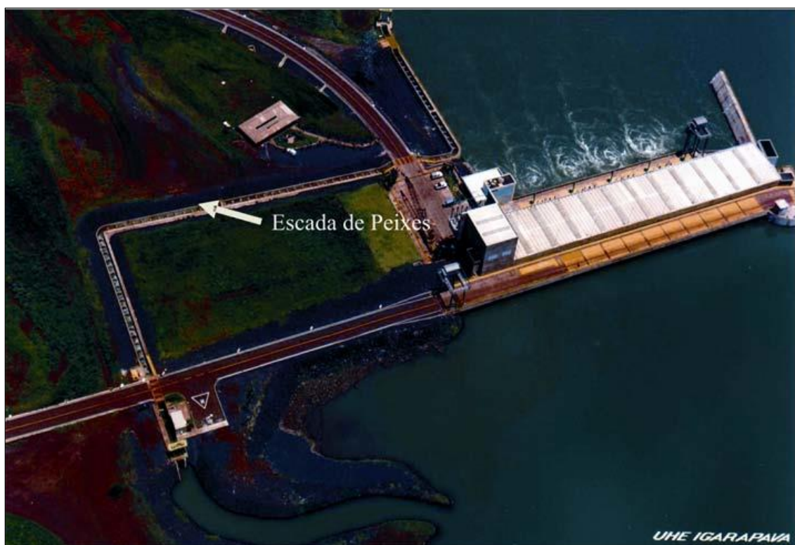
Figura 2 – Modelo de Escada de Peixe UHE de Igarapava (Cemig, 2002).
