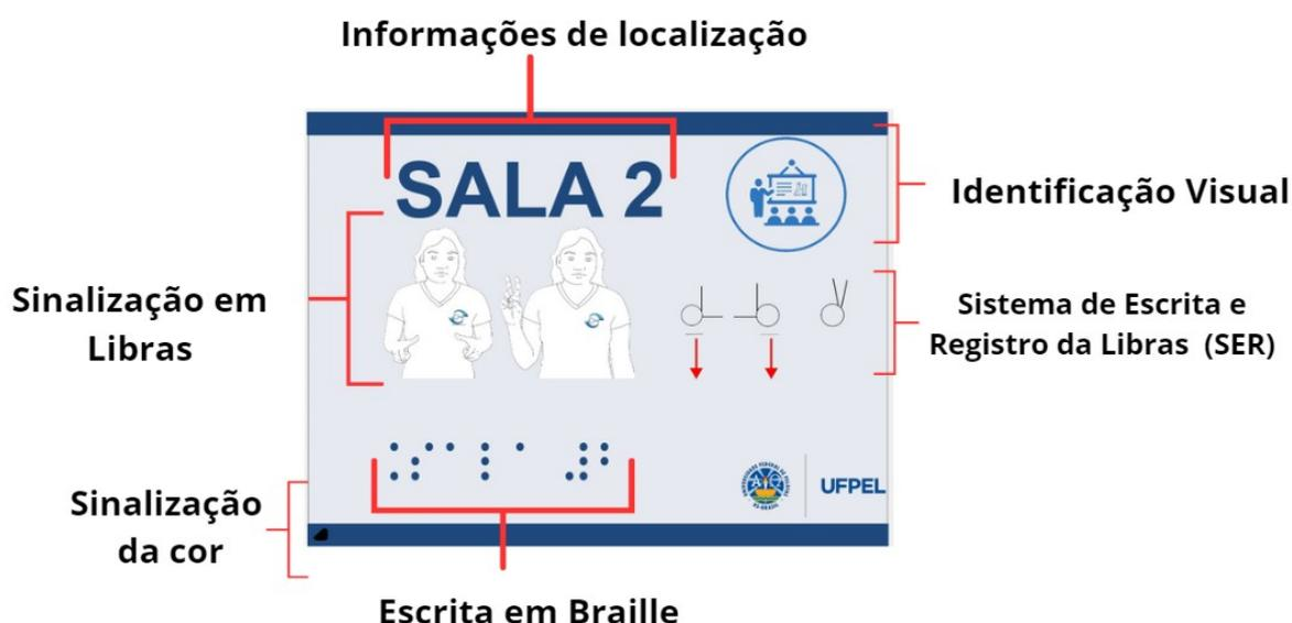
Figura 1 Modelo de placa acessível desenvolvidos pelos autores.
