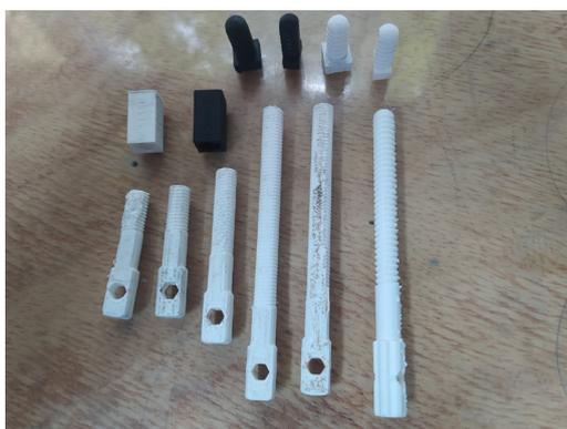
Figura 1: Exemplo de um parafuso e encaixe prototipado no FabLab
