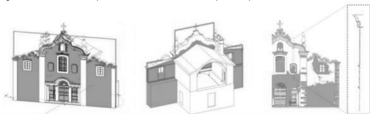
Figura 12 – Paredes de espessuras variadas modeladas a partir de perfis
