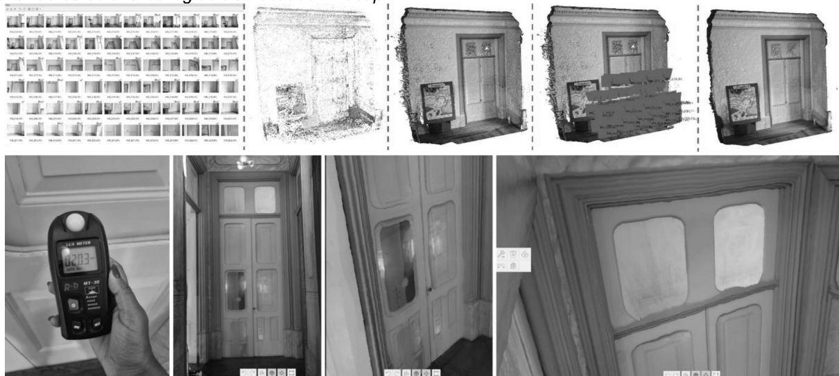
Figura 25 – Ilustrações do processo de criação da nuvem de pontos por meio de fotogrametria, utilizando os softwares Agisoft e Autodesk Recap
