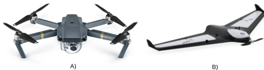
Figura 7: (A) Modelo multirotor fabricante Chinesa DJI; (B) Vant Modelo Horus asa fixa, fabricado no Brasil. Fonte: https://www.dji.com/br/mavic/info ; https://horus.global/tecnologias , (2024).
