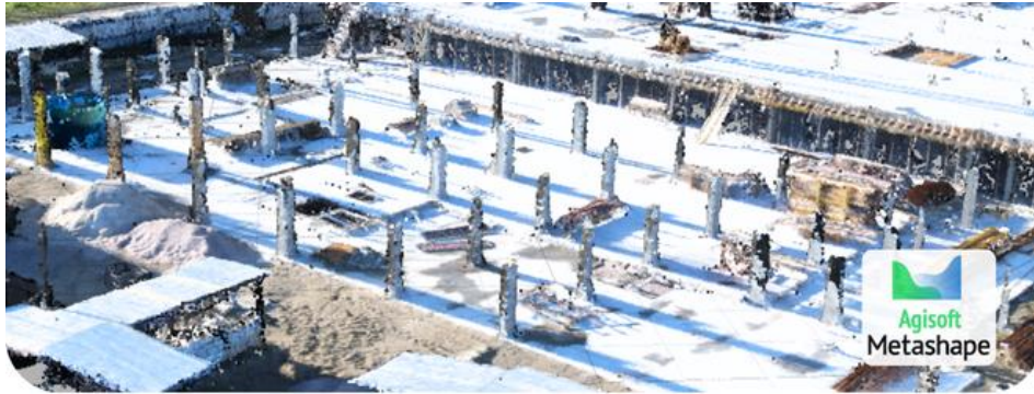
Figura 32: Processamento fotogramétrico, nuvem de pontos densa. Fonte: Agisoft Metashape, 2023.
