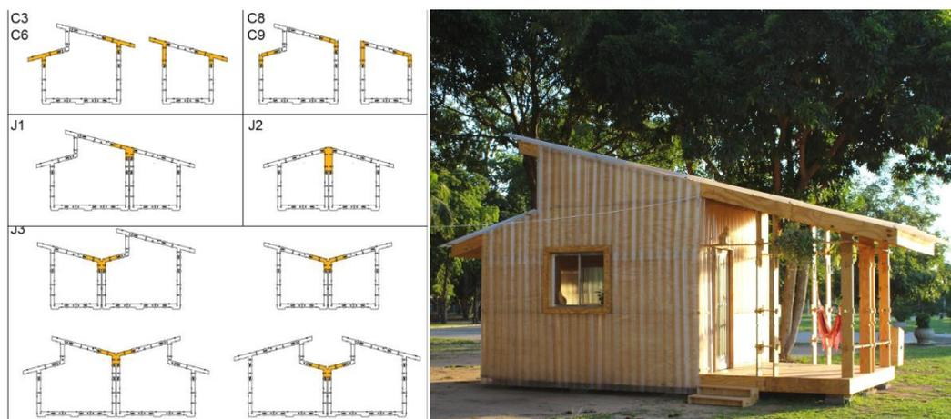
Figura 2.7: A esquerda diagramas de configurações a partir do pórtico. A direita imagem da Casa Revista executada. Fonte: Passaro; Rohde, 2016.
