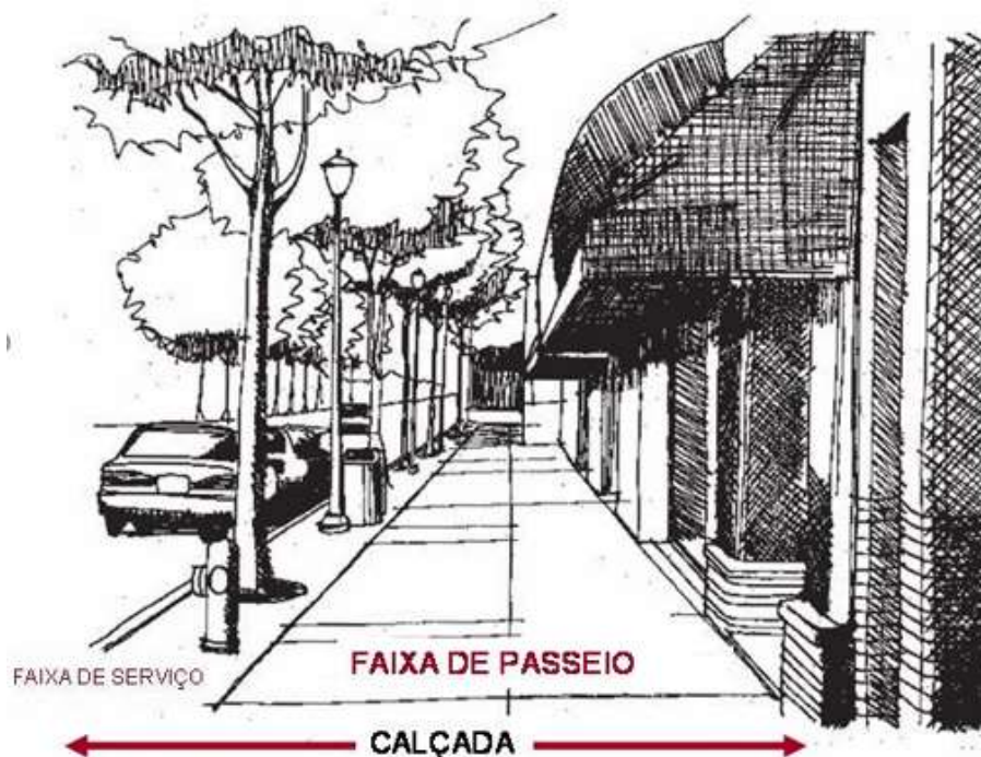
Figura 9 – Distinção entre calçadas e passeio. Fonte: INCLUA-SE, 2010.
