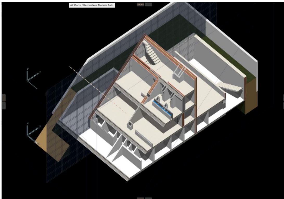
Figura 102 - Malha gráfica configurável auxilia na conferência de proporções. Janela de visualização triidimensional do modelo no Archicad.
