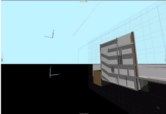
Figura 86 - 3D Corte transversal 8 Perspectiva Esquina, Movimentação do plano de corte em 2,20m
