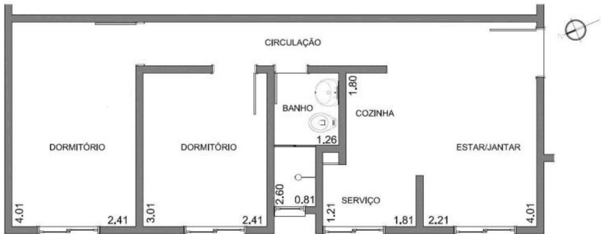
Figura 13 - Planta-baixa do apartamento PAR Porto (dimensões em metros).
