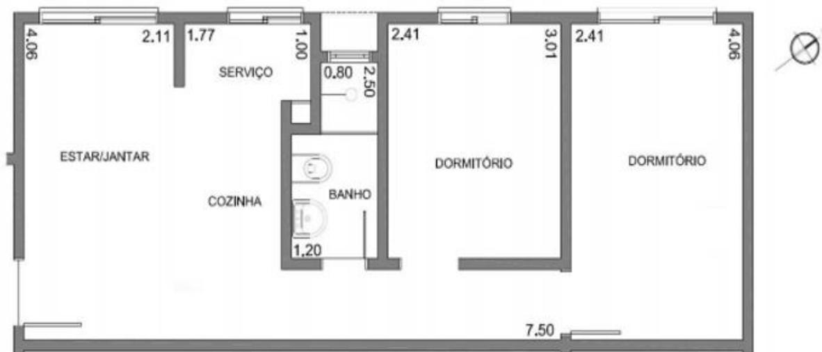
Figura 11 - Planta-baixa do apartamento PAR Regente (dimensões em metros).
