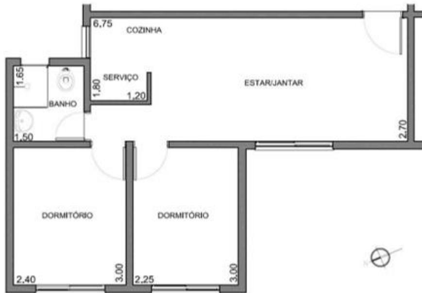
Figura 15 - Planta-baixa do apartamento PAR Solar das Palmeiras (dimensões em metros).
