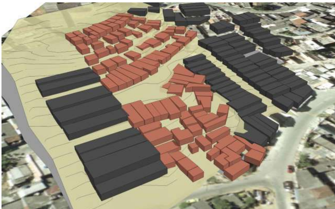
Figura 92: Acima, imagem geral da área de intervenção/demolições. Abaixo, esquema de ocupação zona 2 – em vermelho remoções e em preto edificações mantidas.
