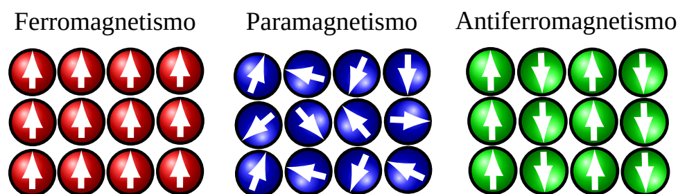
Figura 1 – Representação das fases magnéticas da matéria: ferromagnética (esquerda); paramagnética (centro); antiferromagnética (direita).
