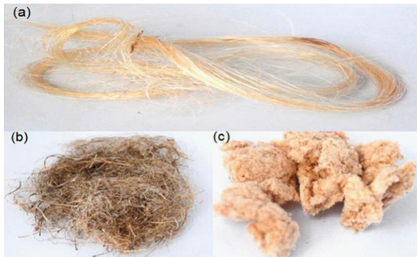
Figura 1 - Fibras longas (a), fibras curtas (b) e polpa (c) derivadas de fibras vegetais.
