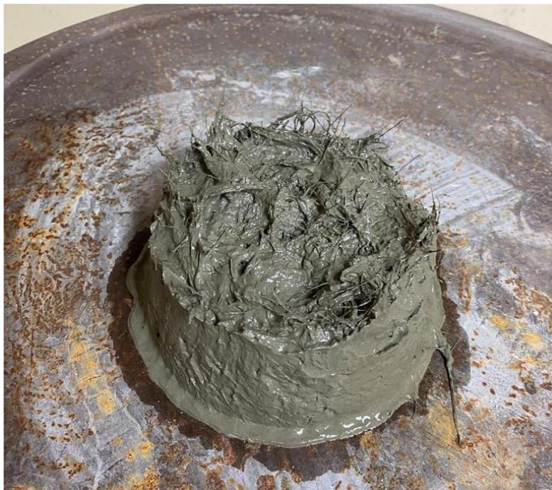
Figura 11 - Análise de fluidez da mistura no *flow table*.
