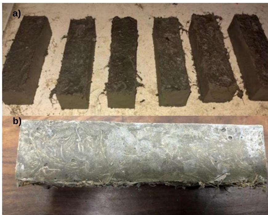
Figura 10 - Espécimes desmoldados (a) e curado sob pressão (b).
