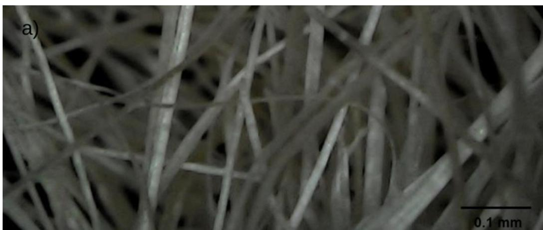
Figura 14 - Micrografias das fibras de sisal obtidas em microscópio ótico.
