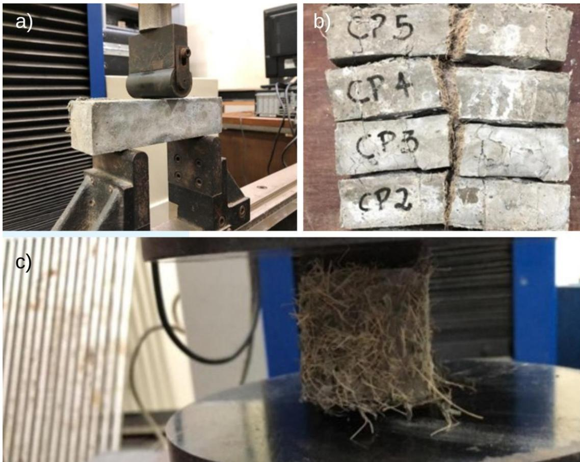
Figura 12 - Espécime no ensaio de flexão em três pontos (a), espécimes após os ensaios mecânicos (b) e espécime na execução do ensaio de compressão (c).
