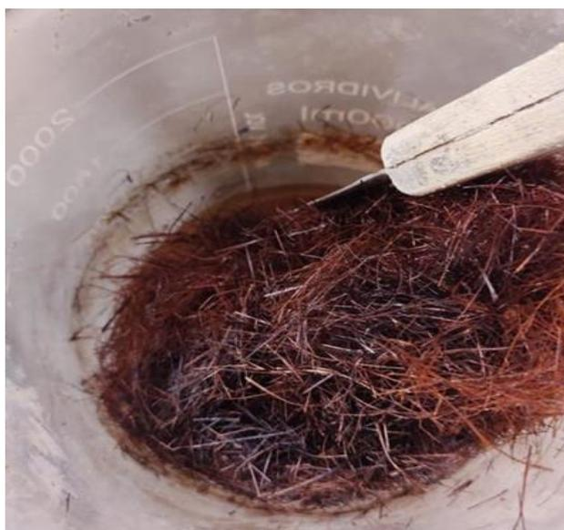
Figura 8 - Fibras de sisal após o tratamento prévio.
