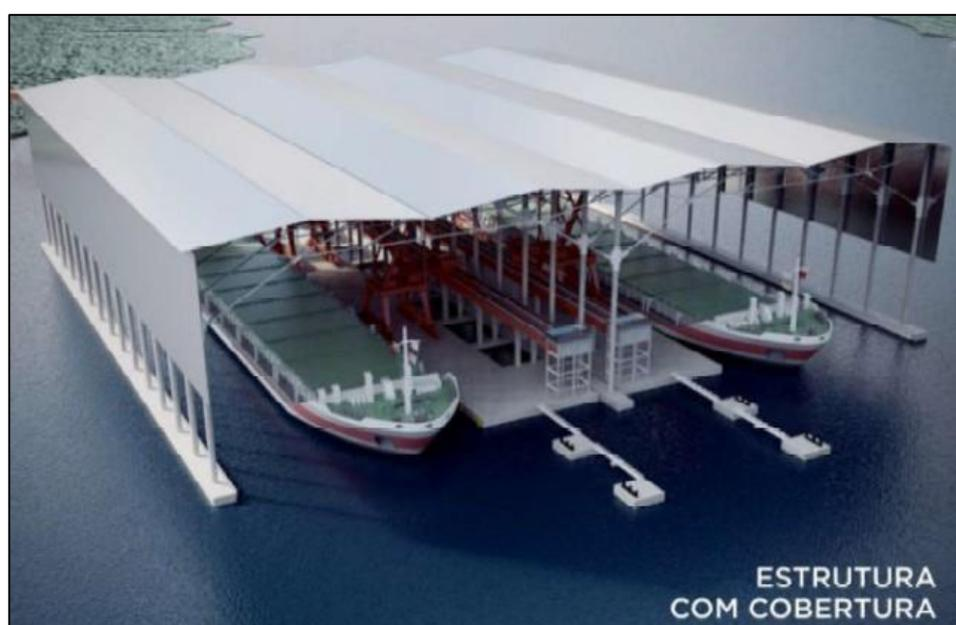
Figura 27 – Projeto de estrutura do tipo “berço de atracação” do Terminal Multimodal São Gonçalo (POGON). Fonte: DTA Engenharia (2022).
