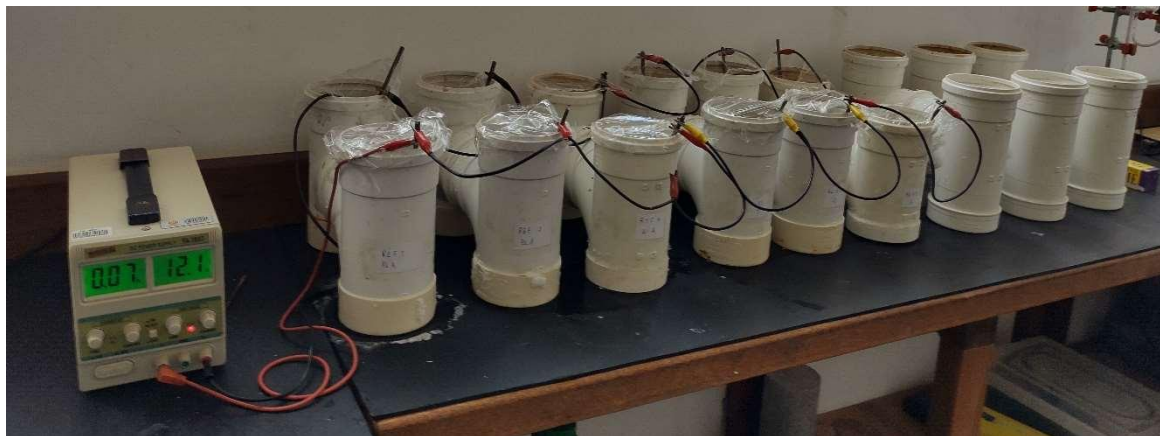
Figura 19 – Realização ensaio UNE 83987. Fonte: Autor.
