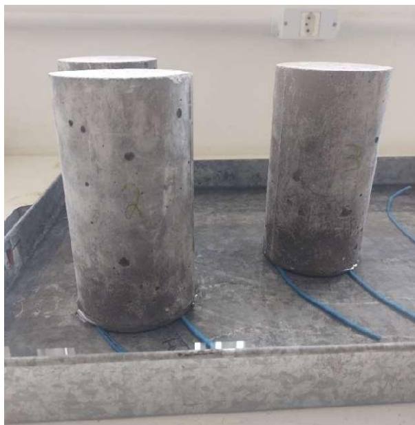
Figura 12 – Realização do ensaio de absorção de água por capilaridade. Fonte: Autor.
