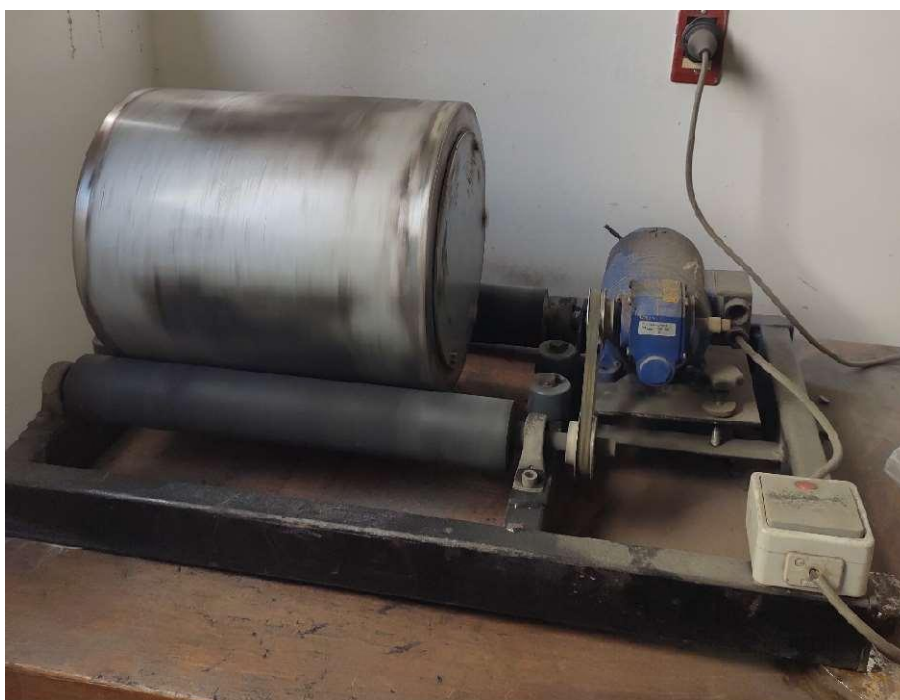
Figura 7 – Realização do processo de moagem da BLA. Fonte: Autor.
