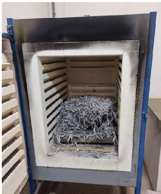
Figura 6 – Forno mufla utilizado para calcinação das folhas de bambu. Fonte: Autor.
