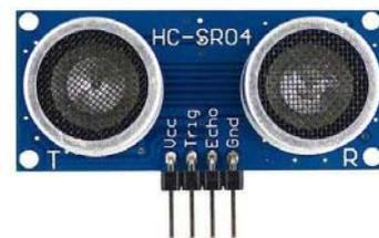
(d) Sensor Ultrassônico modelo HC-SR04
