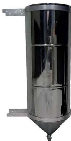
Figura 12 - Pluviômetro do tipo DNAEE instalado na BHUECA
