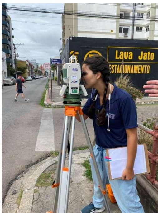
Figura 37 - Fotografia da realização do levantamento do perfil longitudinal e das seções transversais do Canaleta da Argolo
