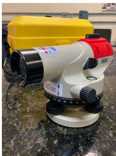
Figura 19 - Nível óptico KL-32 da marca Kolida utilizado para o levantamento geométrico.
