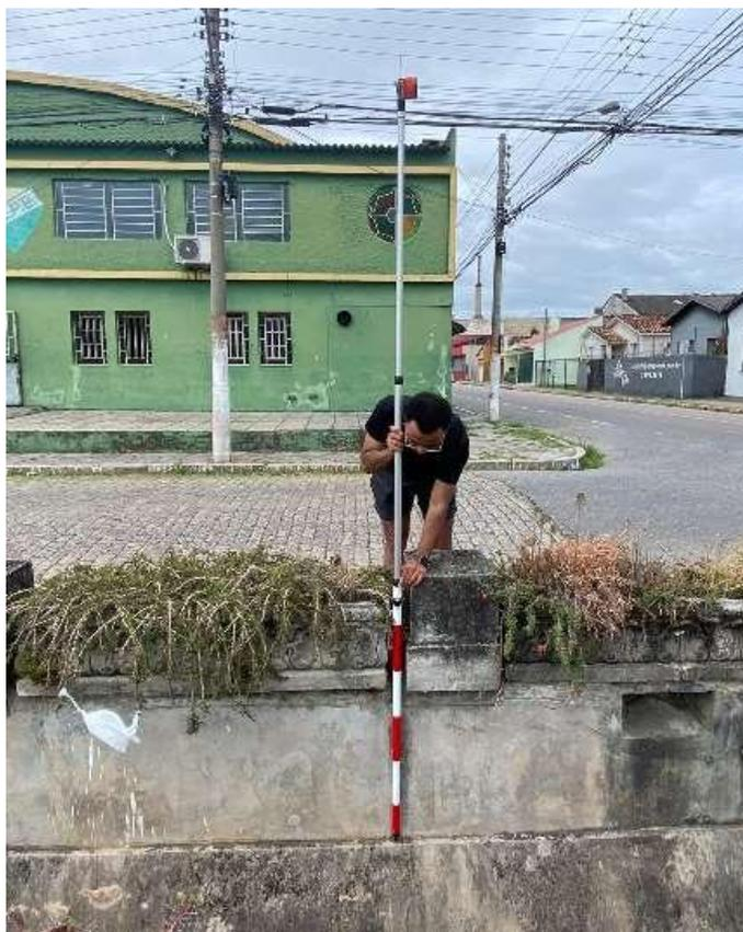
Figura 25 - Bastão e prisma sendo utilizados para levantamento do ponto de interesse.
