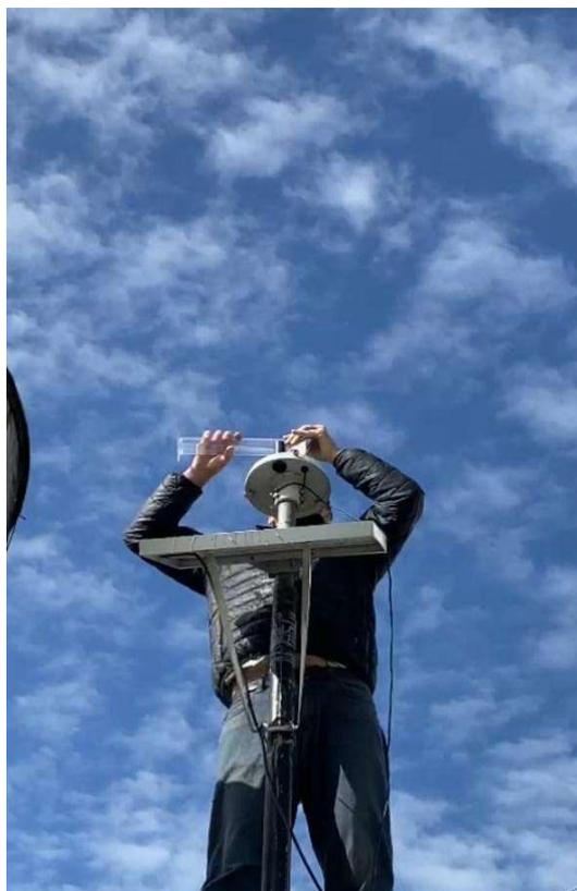
Figura 35 - Calibração da bscula do pluvigrafo
