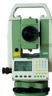
Figura 24 - Estação total RTS 102 da fabricante FOIF utilizado para o levantamento da seção do Canalete da Argolo.
