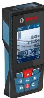
Figura 28 - Trena laser GLM 120 C Professional utilizada no levantamento das sarjetas.
