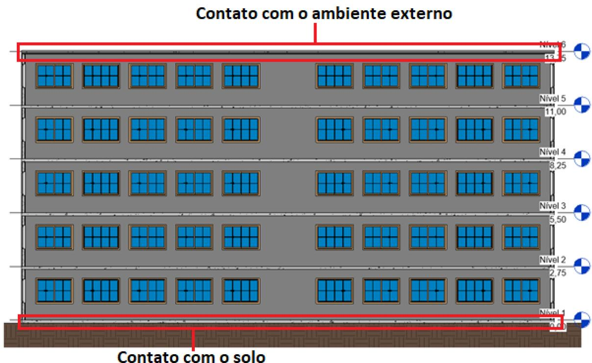
Figura 57 - Análise da condição do piso e da cobertura do protótipo de grandes escritórios
