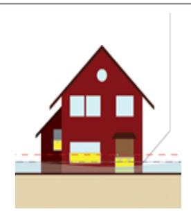
Um diagrama de uma casa com paredes vermelhas e telhado marrom. A base da casa está submersa em água azul. Há barreiras amarelas e brancas ao redor da casa para impedir a entrada da água. Uma linha vermelha tracejada indica o nível da água. |
