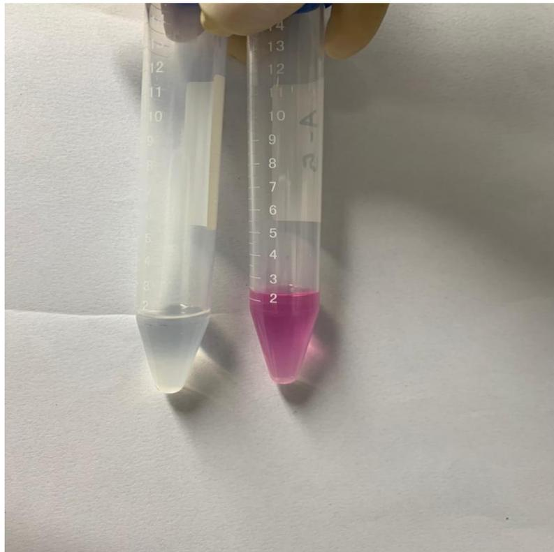
Figura 2. Solução de vermelho de metila após remoção com carvão ativado em 10 minutos e solução inicial de vermelho de metila (20 mg/L).
