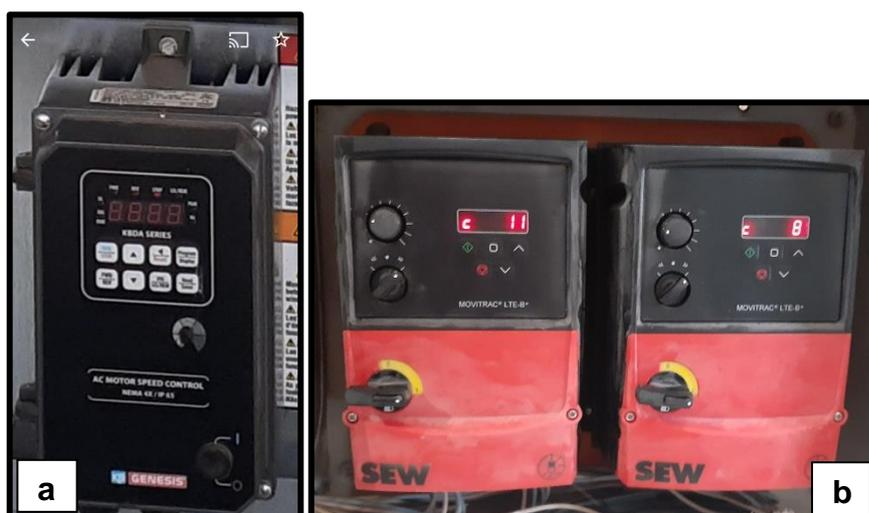
**Anexo 5:** a – Inversor de velocidade do Separador de Espiral Rotativo Profile Industries® desenvolvido para uso em laboratório; b - Inversor de velocidade do Separador de Espiral Rotativo Profile Industries® desenvolvido para uso em uma unidade de beneficiamento de sementes.
