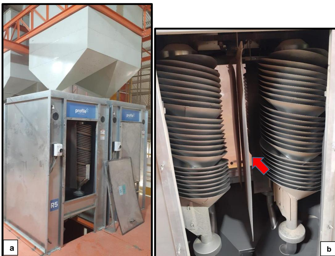
**Anexo 2:** **a** - Separador de Espiral Rotativo Profile Industries® desenvolvido para uso em uma Unidade de Beneficiamento de Sementes; **b** - Cortinas de Etileno Acetato de Vinila (EVA)
