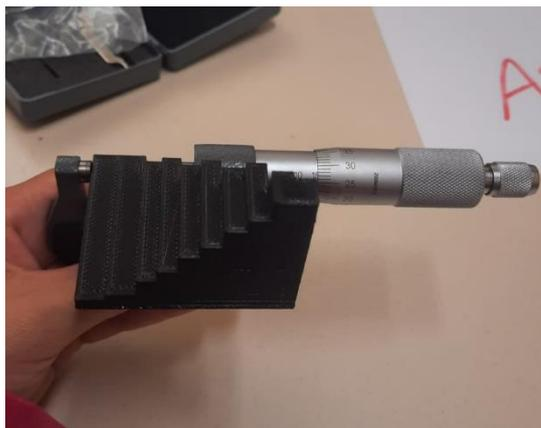
**Figura 2:** Peça em processo de medição com micrômetro.
