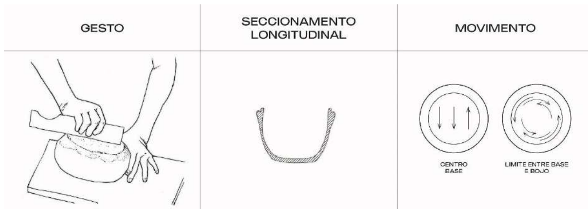
Figura 75: Representação do gesto e movimento de acabamento da peça após a primeira secagem.
