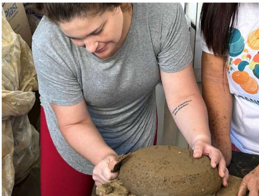
Figura 124: Utilizando o arco para dar acabamento na base da frigideira.
