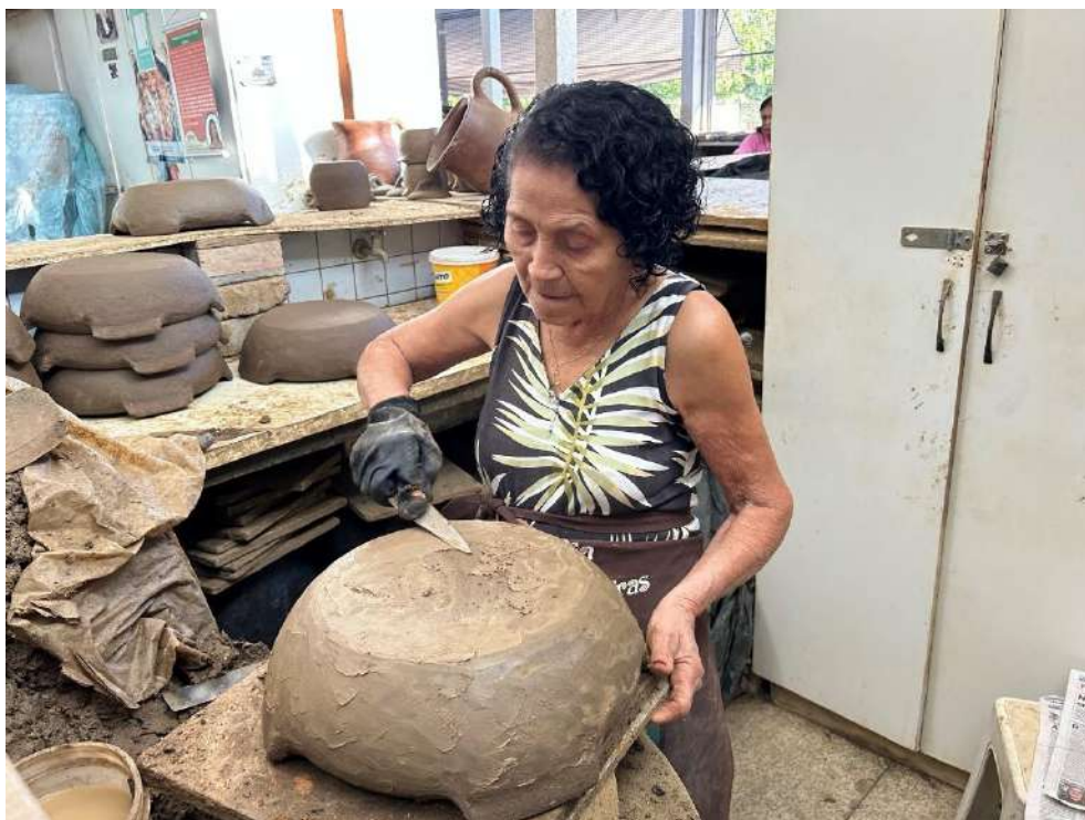
Figura 76: Dona Luci realizando o acabamento com a faca umedecida após a raspagem com o arco.
