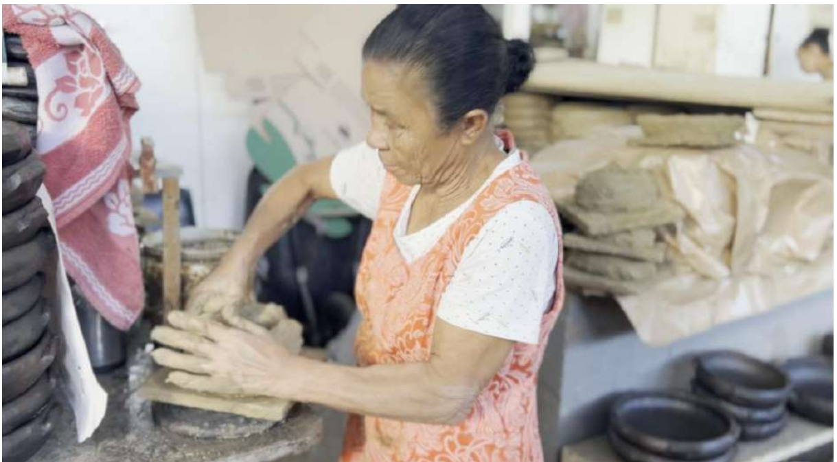
Figura 32: Momento em que a Paneleira começa a girar a tábua sobre a superfície a fim de dar forma circular à panela.
