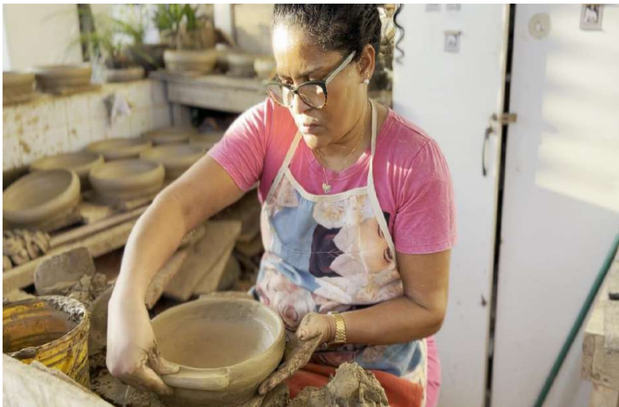
Figura 57: Após umedecer os dedos, a Paneleira começa a trabalhar na forma da alça, realizando o acabamento.
