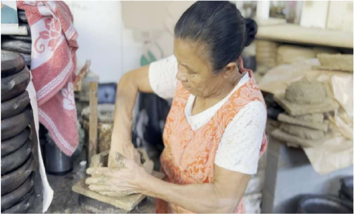
Figura 39: Após adicionar a água, com os punhos cerrados, dá-se o ajuste no fundo e nas paredes para dimensionar o tamanho do utensílio.
