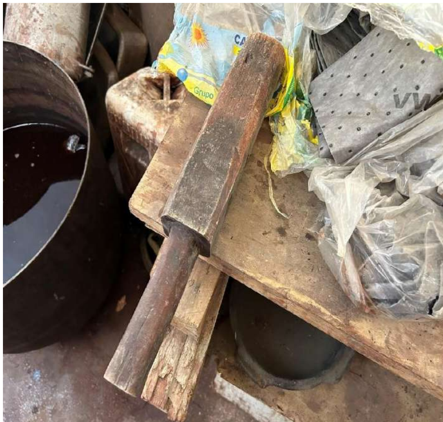
Figura 104: Bastão de madeira utilizado para extrair a casca da árvore e macerá-la posteriormente.
