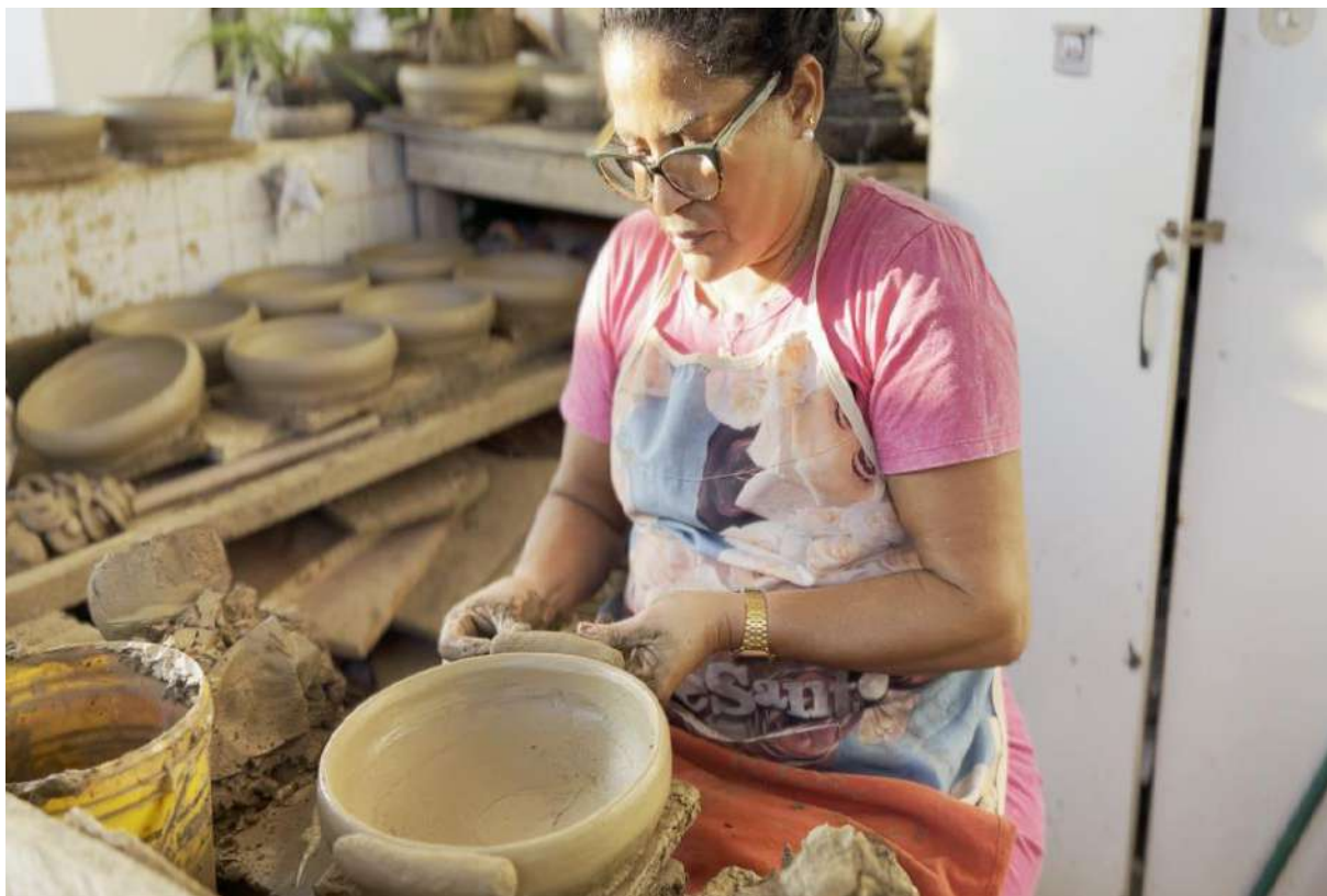
Figura 55: Inserção da alça na frigideira (panela de moqueca).
