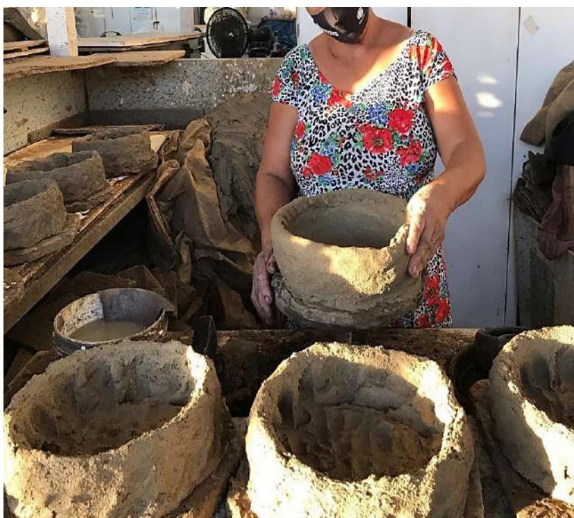
Figura 45: técnica de modelagem manual aplicada na confecção das panelas de Goiabeiras pela Paneleira Eronildes Correa de Menezes. Nota-se a marca dos dedos na massa ainda úmida, antes da etapa de alisamento com a cuia.
