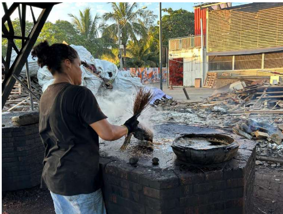
Figura 94: A Paneleira Jecilene segurando a muxinga na mão direita para açoitar a panela.
