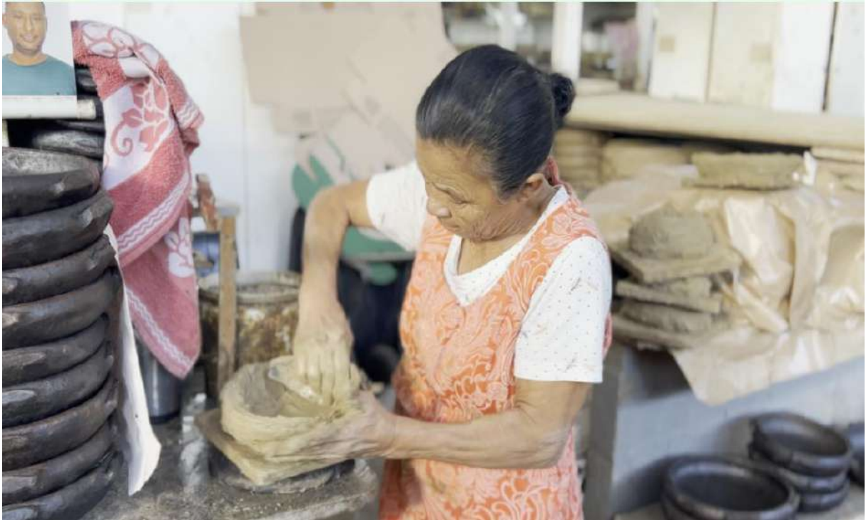
Figura 43: Acabamento com a utilização da cuia de coité úmida na parte interna do vasilhame.
