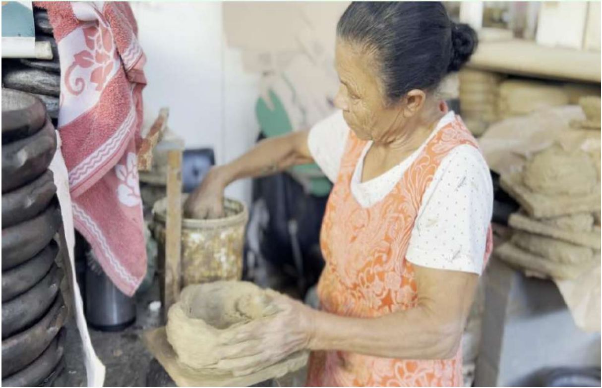
Figura 37: Adição de água na massa para umedecê-la e facilitar o processo de "puxar".
