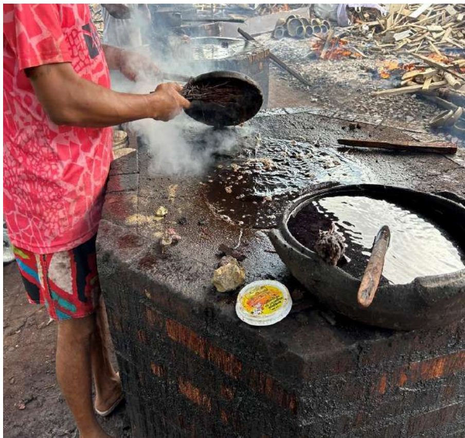
Figura 110: Evandro Rosa utiliza um cabo de madeira na mão esquerda para auxiliar o manuseio da panela ainda muito quente, enquanto açoita a peça com a vassoura de muxinga embebida no tanino com a mão direita.
