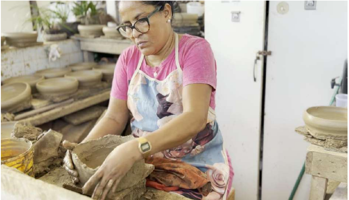
Figura 36: Processo em que a tábua é girada com as mãos, já com as paredes levantadas, desempenhando uma função semelhante a do torno para dar a forma à panela.
