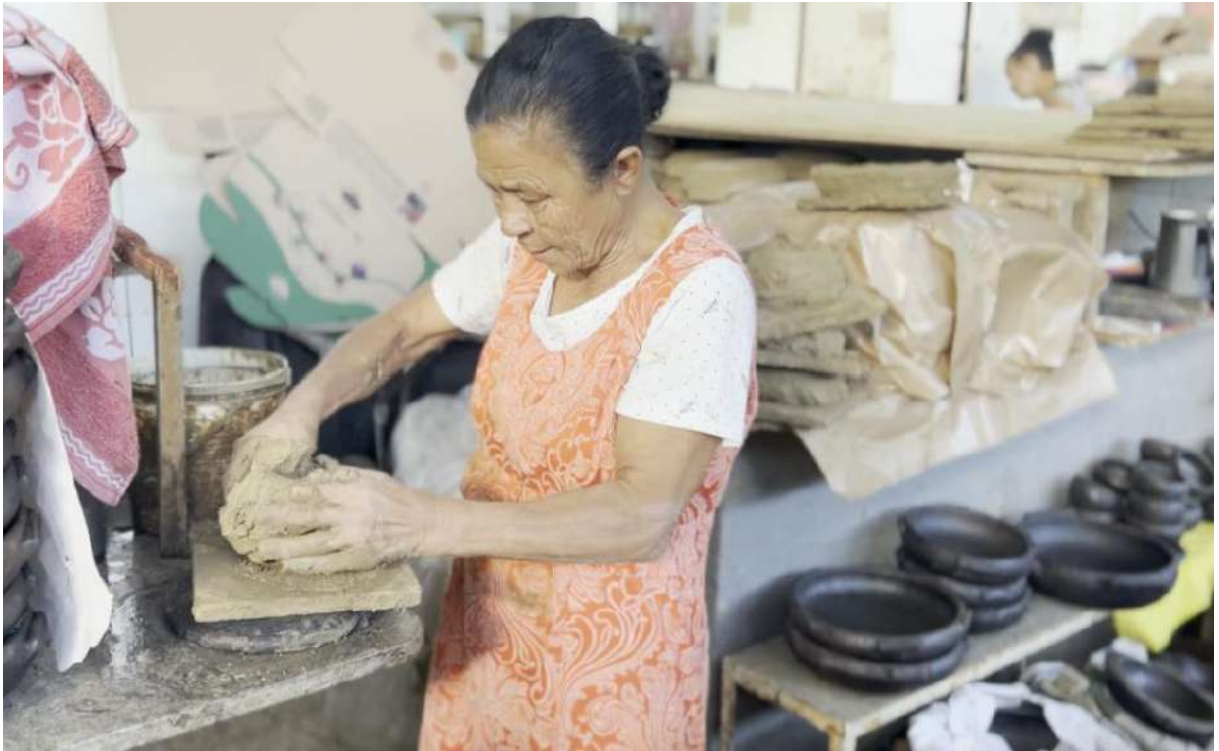
Figura 31: A Paneleira Evanilda dá início à modelagem manual com a massa já na tábua, fazendo um furo no centro.
