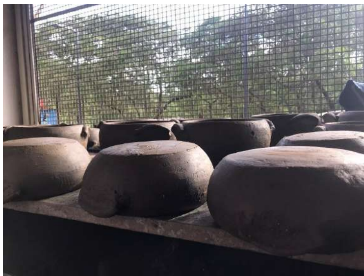
Figura 78: Panelas emborçadas em processo de secagem após passarem pela raspagem com o arco e acabamento com a faca umedecida.
