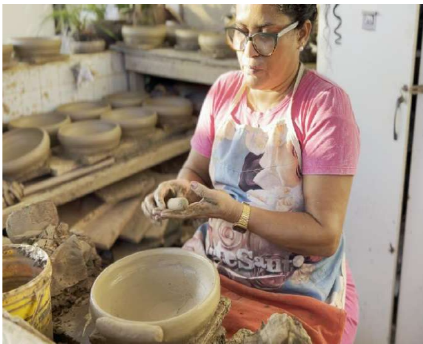
Figura 54: A Paneleira Rejane preparando a asa do tipo alça para ser adicionada na proximidade da borda de uma frigideira (panela de moqueca).
