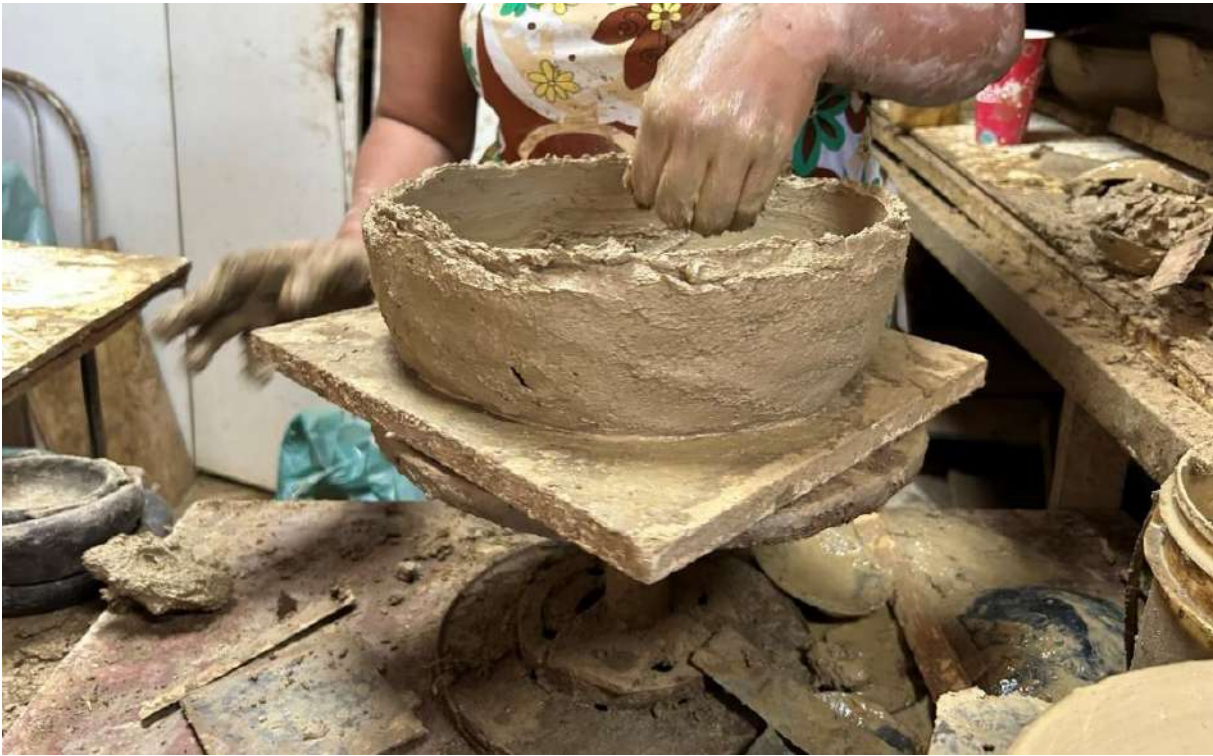
Figura 34: Atualmente, algumas artesãs contam com um torno manual simples para auxiliar no movimento circular para modelagem das peças.
