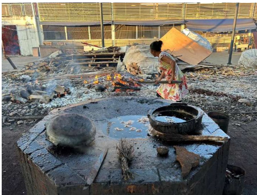
Figura 92: A Paneleira Evanilda Correa retirando sua panela da fogueira para realizar a etapa de impermeabilização com aplicação de tanino.
