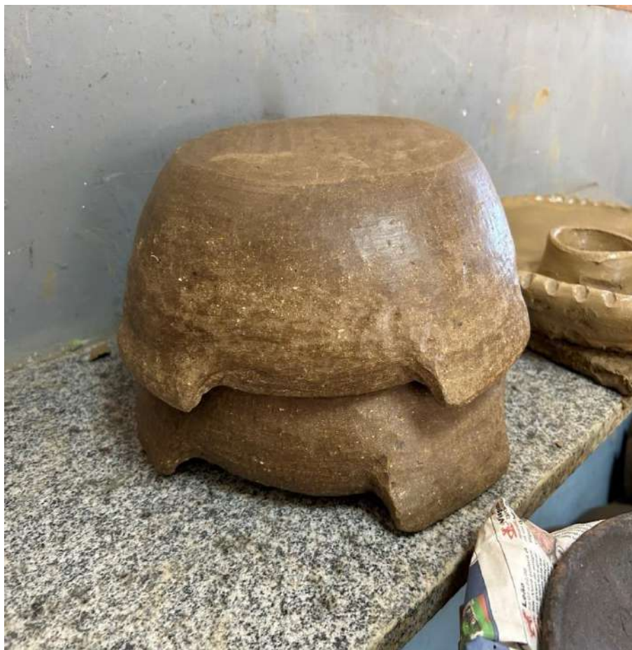
Figura 83: Panelas alisadas (polidas/brunidas) em processo de secagem total para ir para a fogueira.
