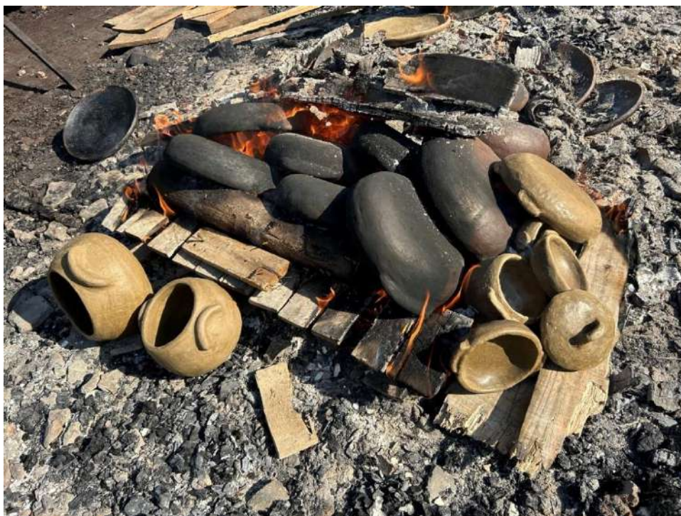
Figura 89: Organização da fogueira para queima das panelas. Nota-se que há panelas já queimadas e outras que ainda estão completamente cruas. Também é possível observar lenha queimada sobre as panelas, o que pode causar redução na queima.
