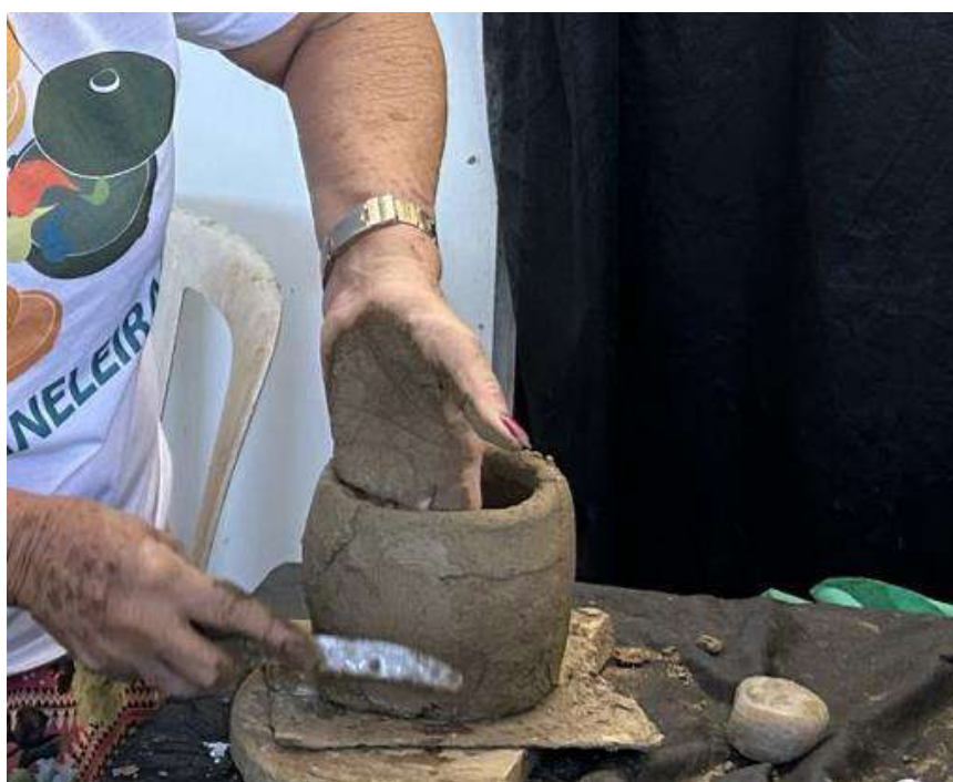
Figura 66: Com auxílio de uma faca umedecida na água, inicia a etapa de alisamento da face externa
