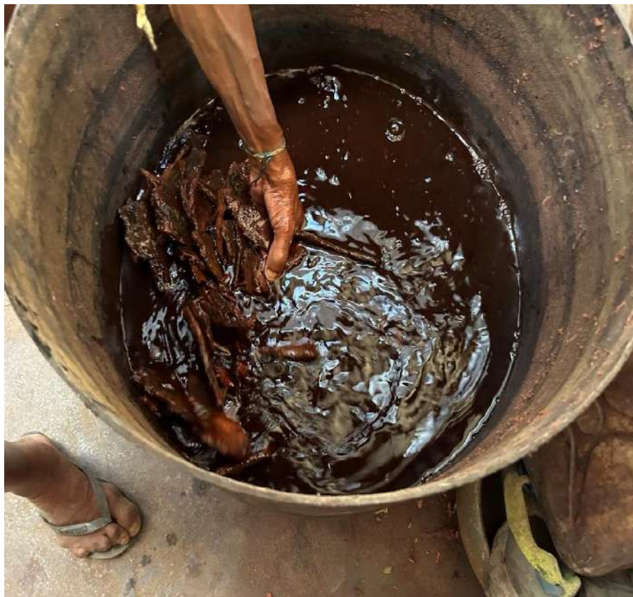
Figura 105: A casca da árvore é depositada em um tonel com água, onde irá permanecer por um período de sete dias.
