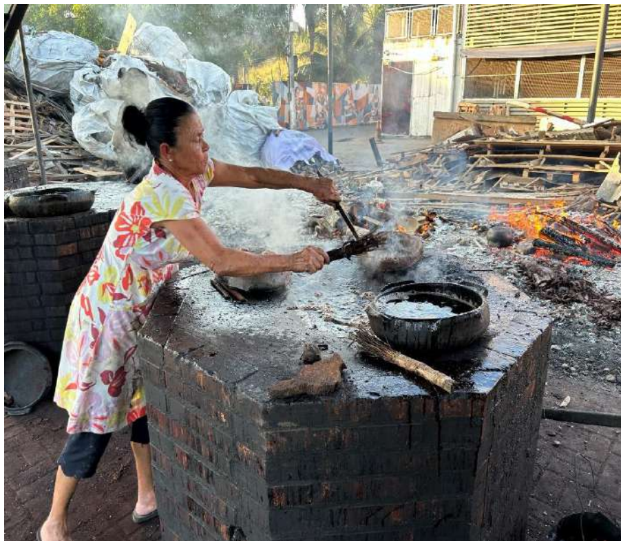
Figura 108: A Paneleira Evanilda açoitando com a vassoura de muxinga as peças que acabara de queimar.
