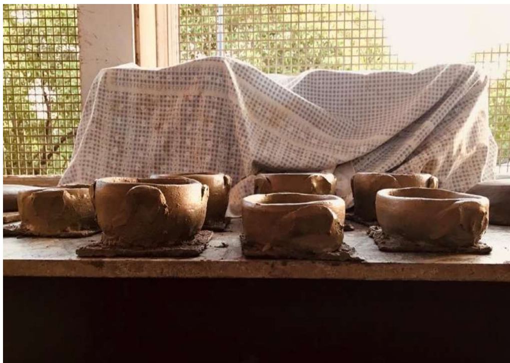
Figura 71: Panelas recém modeladas e colocadas para secagem dentro do galpão. Nota-se que a massa ainda está bem úmida.
