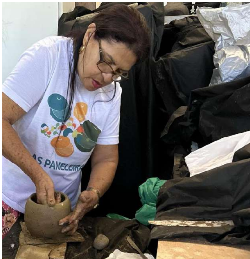
Figura 69: Últimos retoques na borda para ajustar a forma final do utensílio.
