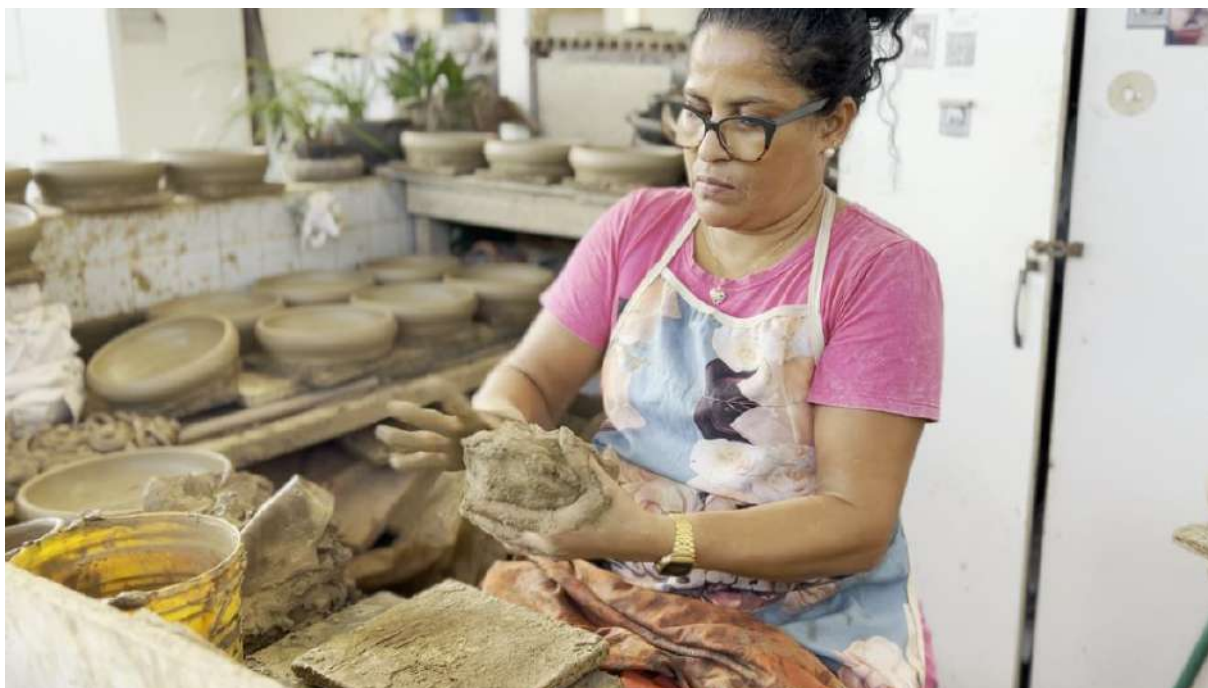
Figura 28: Momento em que a Paneleira Rejane Correa Loureiro começa a puxar o barro antes de colocá-lo sobre a tábua de auxílio, executando o furo no centro da massa.
