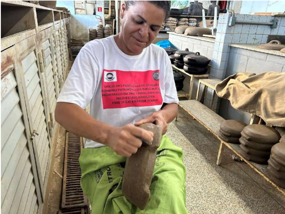
Figura 80: A Paneleira Jecilene alisando (polindo) uma frigideira.
