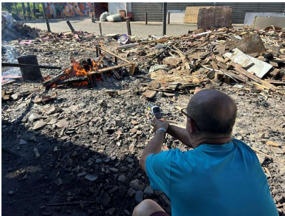
Figura 88: Medição da temperatura da fogueira durante o processo de queima das Placas de Goiabeiras com auxílio de termômetro digital infravermelho.
