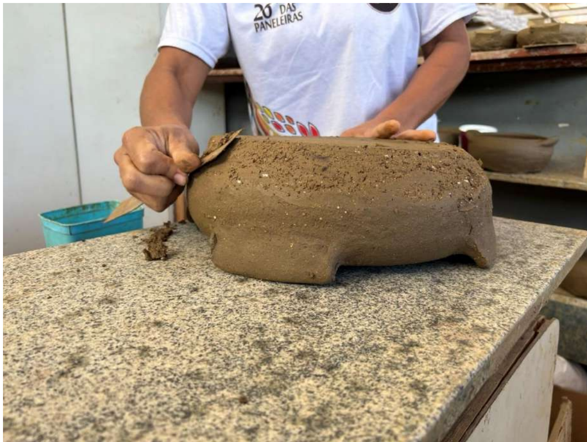
Figura 74: Acabamento feito com a panela virada, no ponto de couro, com o auxílio do arco na mão direita da artesã.
