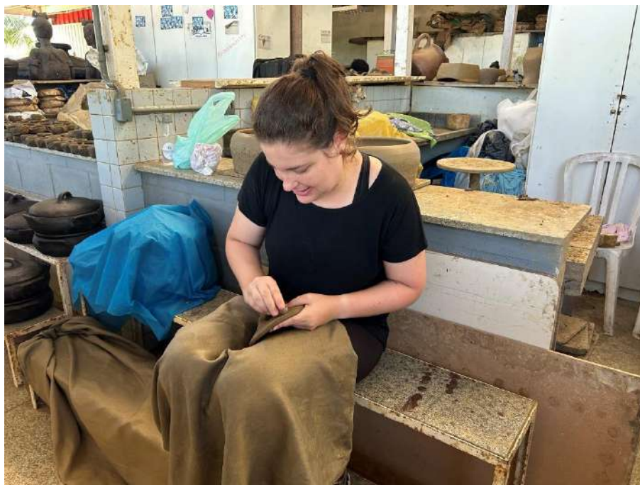
Figura 125: Processo de polimento de uma tampa.
