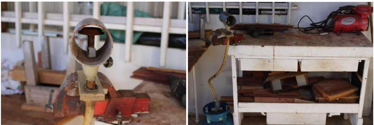
Figura 31 - Estrutura feita por Senhor Cabral a partir de uma "boca" de fogão e um pedaço de panela
