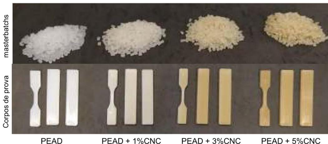
Figura 1 – Fotografias dos masterbatches e corpos de prova usados nos ensaios mecânicos.
