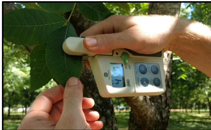
Figura 5 – Avaliação de clorofila com equipamento SPAD. Santa Rosa-RS. HELLWIG, C.G., 2019.
