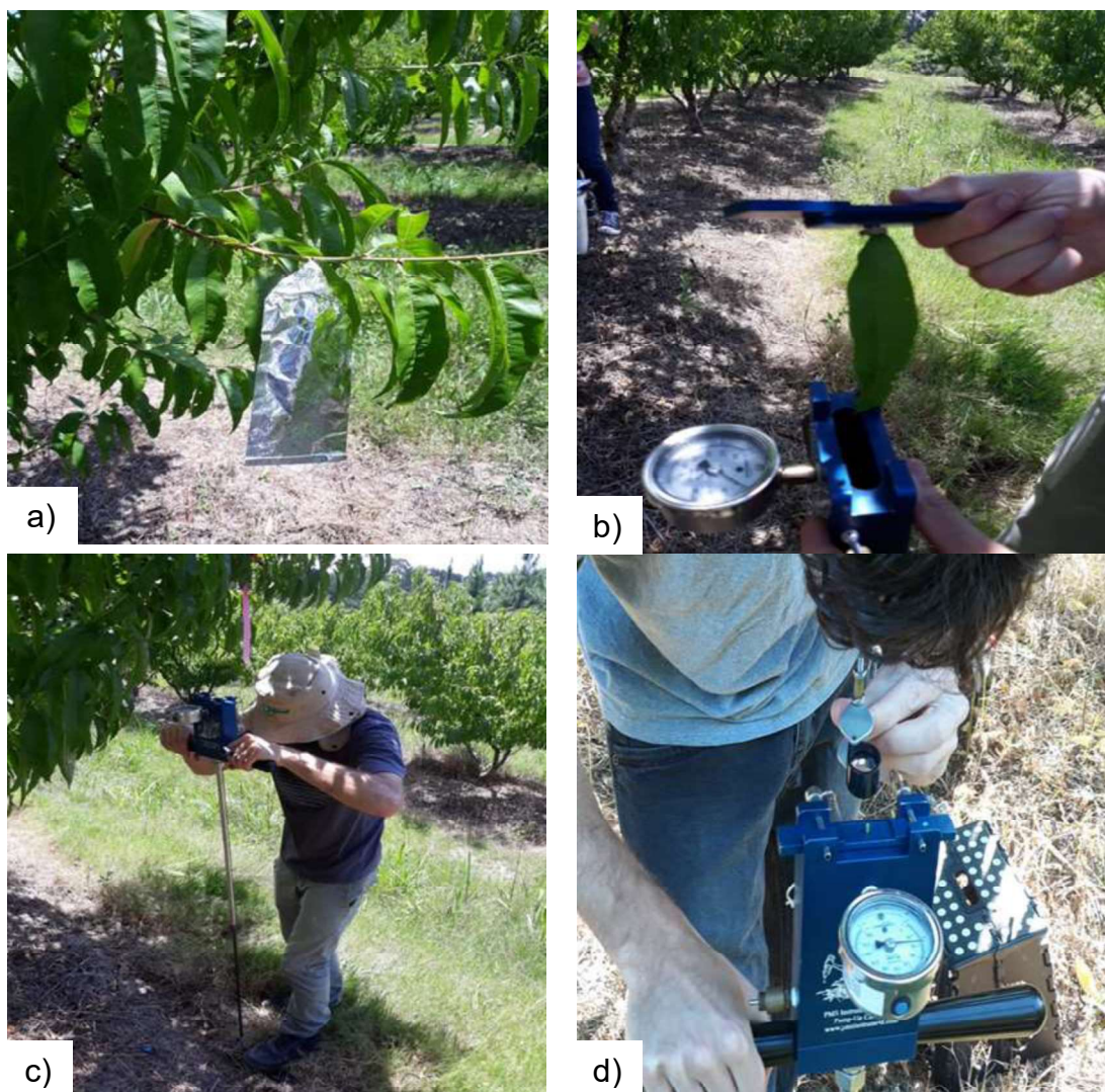
Figura 5. a) Folha envelopada com papel alumínio por, pelo menos, 20 minutos; b) Inserção do pecíolo na tampa da câmara de pressão; c) Bombeamento manual da câmara de Schoalander; d) Leitura da pressão na saída da primeira bolha d'água do pecíolo através de lupa acoplada na parte superior da câmara. Fotos a): Guilherme Nicolao; b); c e d): Newton Alex Mayer.
