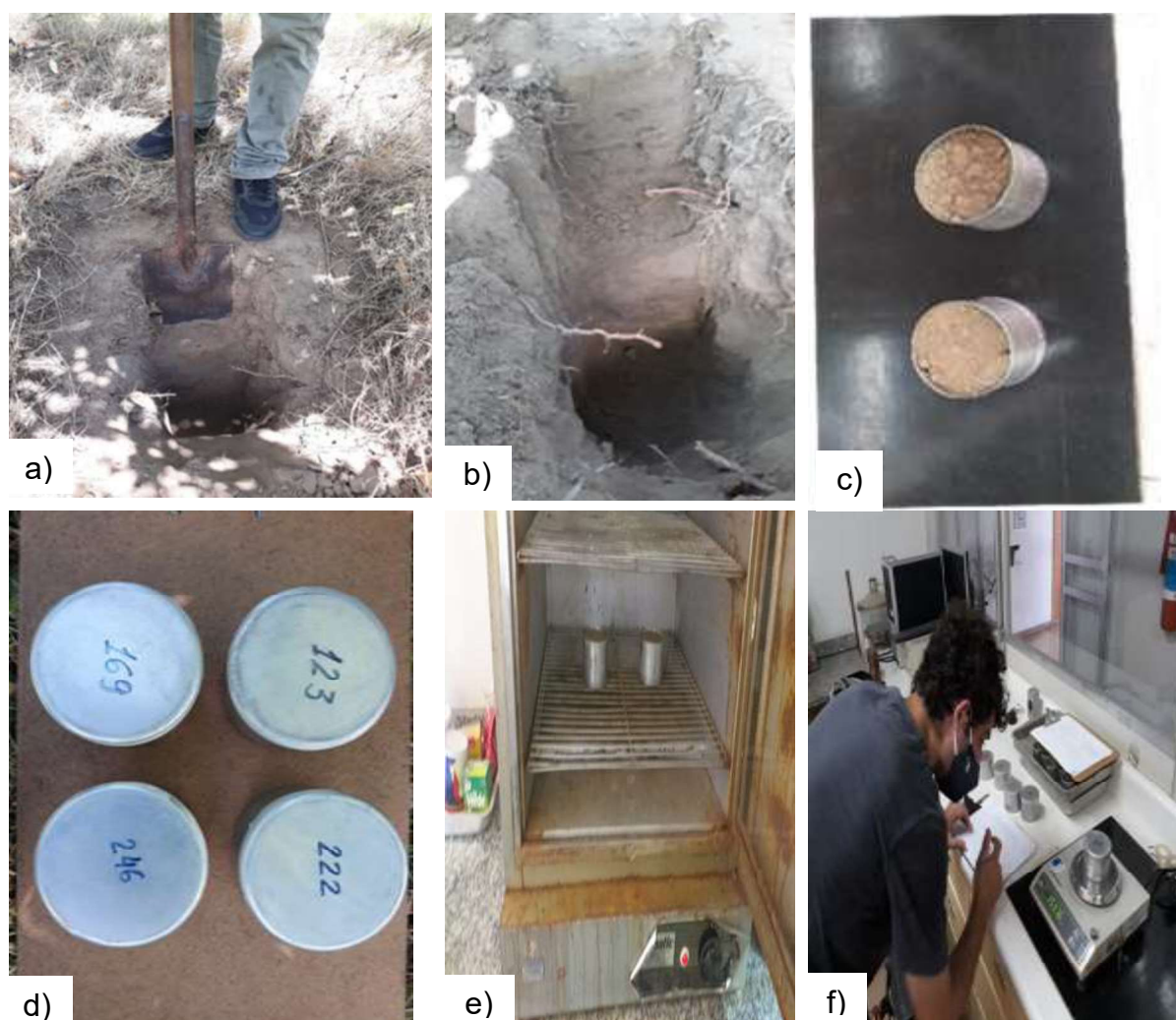
Figura 7. a) Abertura de trincheira com pá de corte, para coleta de amostras de solo; b) Cortes verticais de 0-20 e 20-40 cm de profundidade; c) Amostras de solo deformadas em cápsulas de alumínio; d) Cápsulas de alumínio com massa conhecida e numeradas; e) Amostras de solo colocadas em estufa a 105°C até atingir massa constante; f) Pesagem de amostras de solo seco em balança com precisão de duas casas após a vírgula. Fotos: a); b) e f): Newton Alex Mayer. c); d) e e): Guilherme Nicolao.
