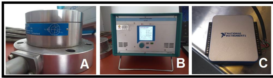
Figura 35 - A) Dinamômetro piezelétrico (célula de carga); B) Amplificador de sinais; C) Placa de aquisição de sinais Fonte: Próprio autor
