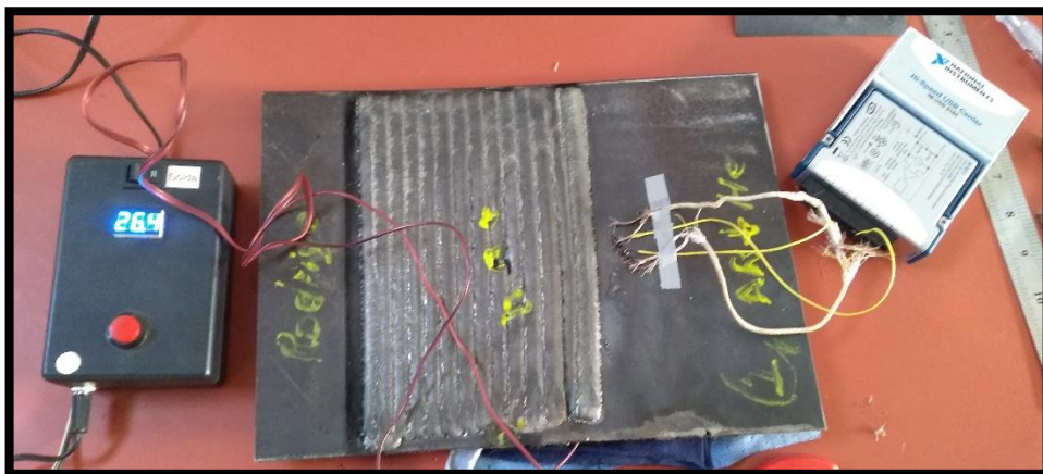
Figura 29 - Fixação dos termopares Fonte: Próprio autor
