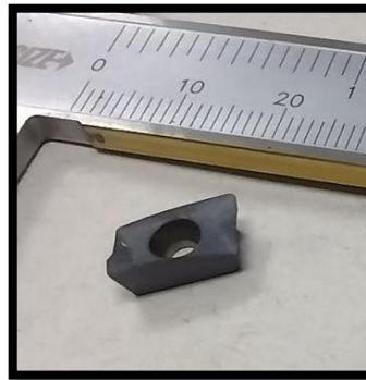
Figura 33 - Inserto APKT 1003 PDTR LT30 Fonte: Próprio autor
