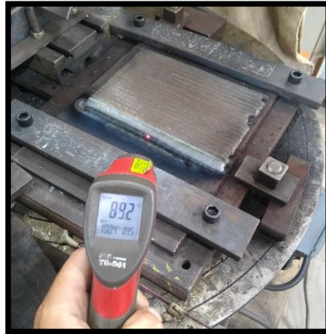
Figura 28 - Medição de temperatura Fonte: Próprio autor
