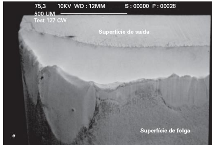
Figura 21 - Vista geral do desgaste de uma ferramenta de metal duro K20 após usar Ti6Al4V Fonte: Machado et al. (2015)
