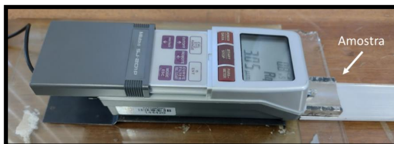
Figura 42 - Medição da rugosidade Fonte: Próprio autor
