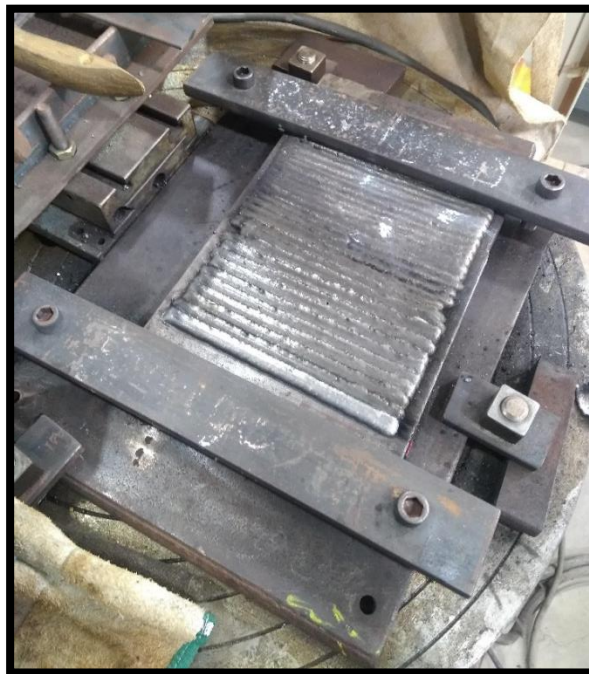
Figura 27 - Suporte para fixação das placas de teste
