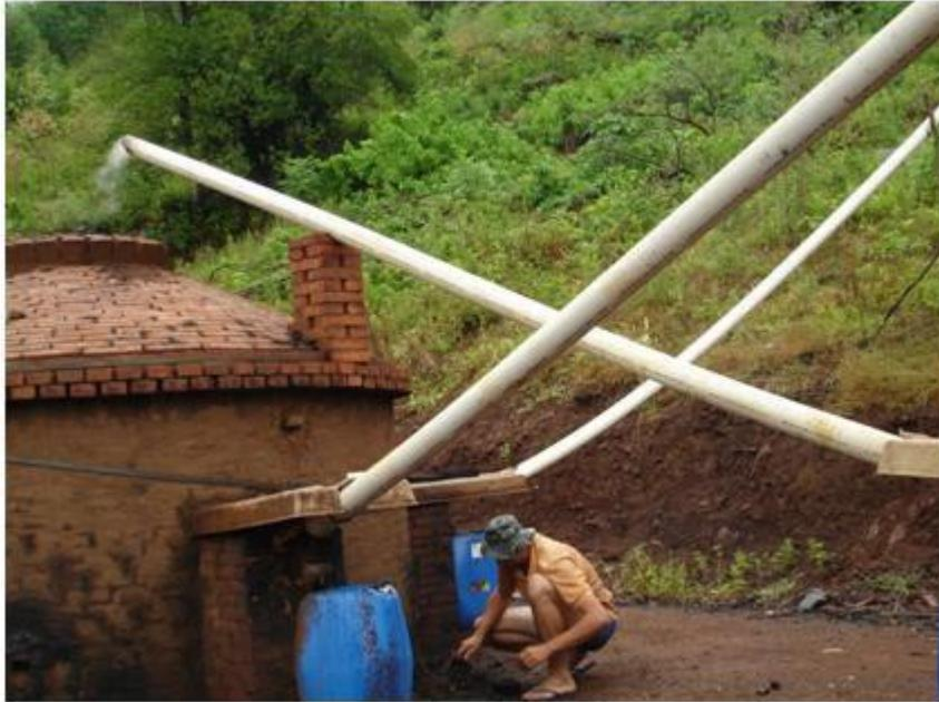
**Figura 2.** Vista de um forno convencional de produção de carvão vegetal adaptado para a coleta de ácido pirolenhoso.
