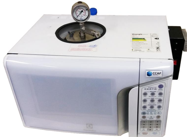
Figura 6 – Microondas de síntese HAM/SAM utilizado para sintetização dos óxidos cerâmicos de características semicondutoras, localizado no campus Anglo, laboratório de pesquisa - (CCAF).
