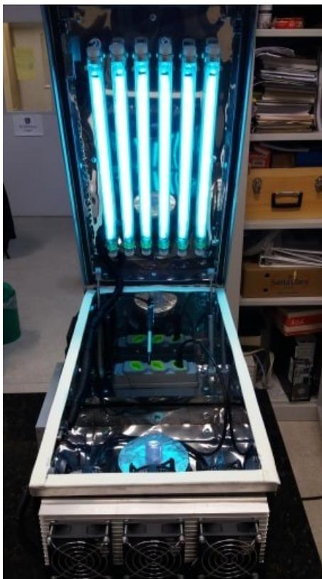
Figura 10 – Interior da caixa de fotocatalise com exposiao das lampadas UV, localizado no campus Anglo, laboratorio de pesquisa - (CCAF).
