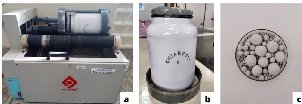
Figura 1 - (a) Moinho de bolas, (b) jarro de porcelana e (c) esferas de porcelana de diferentes tamanhos.
