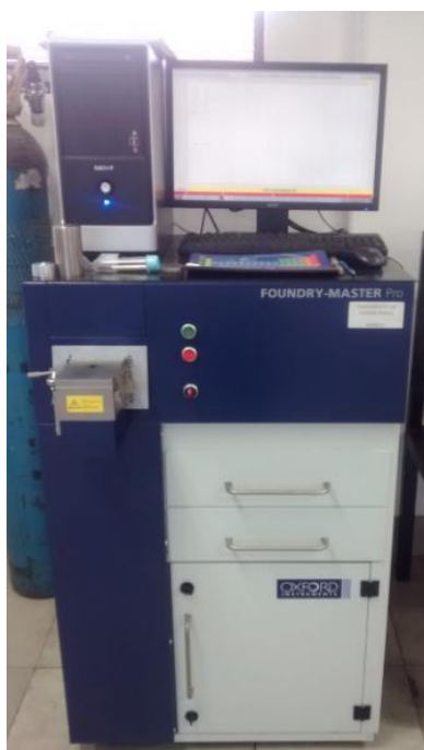
Figura 19 - Espectrômetro de emissão óptica da Oxford, modelo Foundry-Master.
