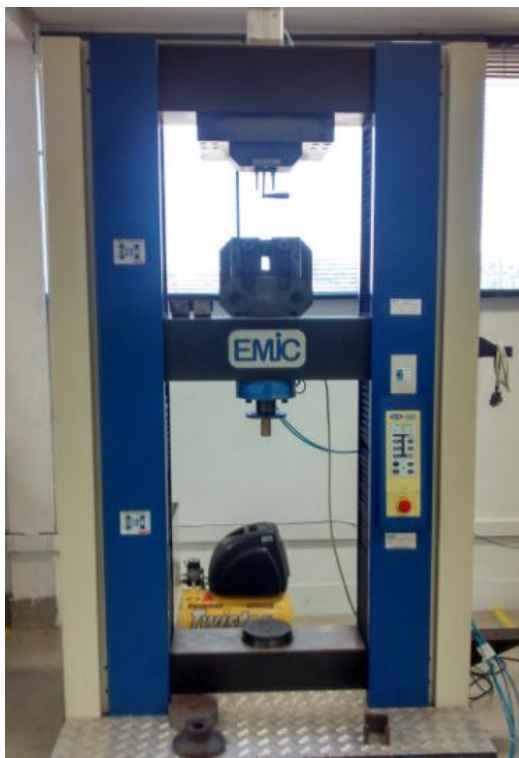
Figura 22 - Máquina Universal de Ensaio Mecânicos EMIC (DL30000).
