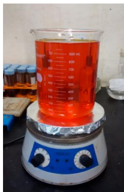
Figura 28 - Etapa de imersão em solução: 50 ml ( \text{H}_3\text{PO}_4 ), 20 g ( \text{CrO}_3 ) e 950 ml ( \text{H}_2\text{O} ).
