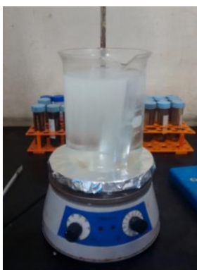
Figura 27 - Etapa de preparação dos corpos-de-prova antes da imersão em solução de \text{NaCl} e \text{H}_2\text{O}_2 .
