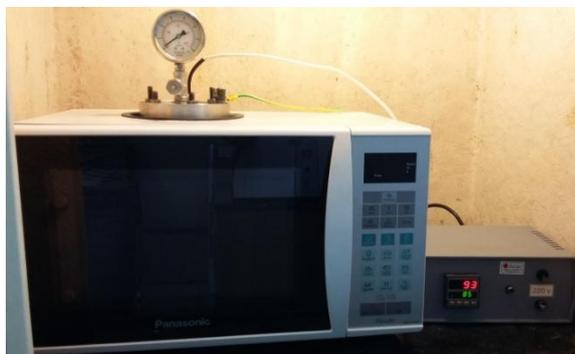
Figura 13 - Equipamento micro-ondas utilizado na síntese de Nb<sub>2</sub>O<sub>5</sub>.
