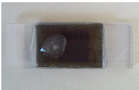
Figura 21 - Imagem da DSSC após a montagem.
