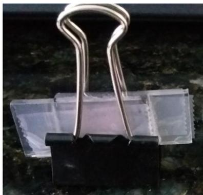
Figura 20 - Processo de junção e colagem da DSSC.
