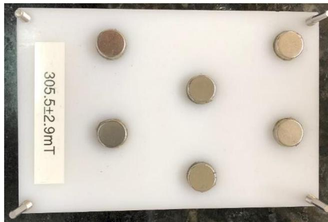
**Figura 1**– Foto do dispositivo criado pela Bioengenharia do HCPA, utilizado para as estimulações magnéticas das placas com células em cultivo.
