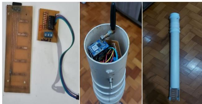
Figura 3 – (a) Circuito de amplificação e conversão D/A e sensor resistivo (b) Suporte de PVC com sistema inserido
