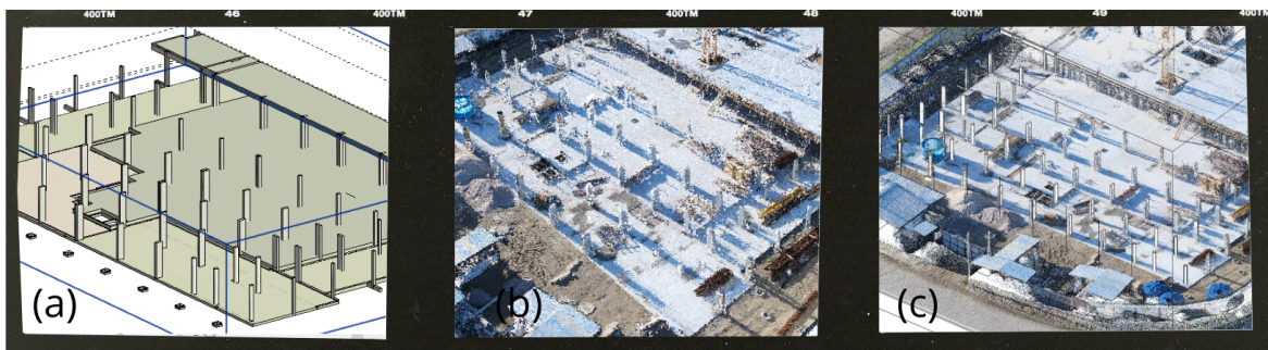
IMAGEM 02: (a) Modelo desenvolvido anteriormente; (b) Modelo Nuvem de pontos; (c) Modelo sobreposto. Fonte: o Autor, 2022
