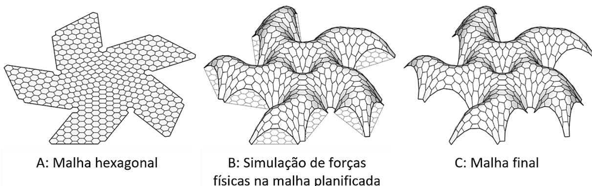
Figura 7.8 Processo de aplicação e simulação das forças físicas na malha hexagonal do Pavilhão Shellstar.
