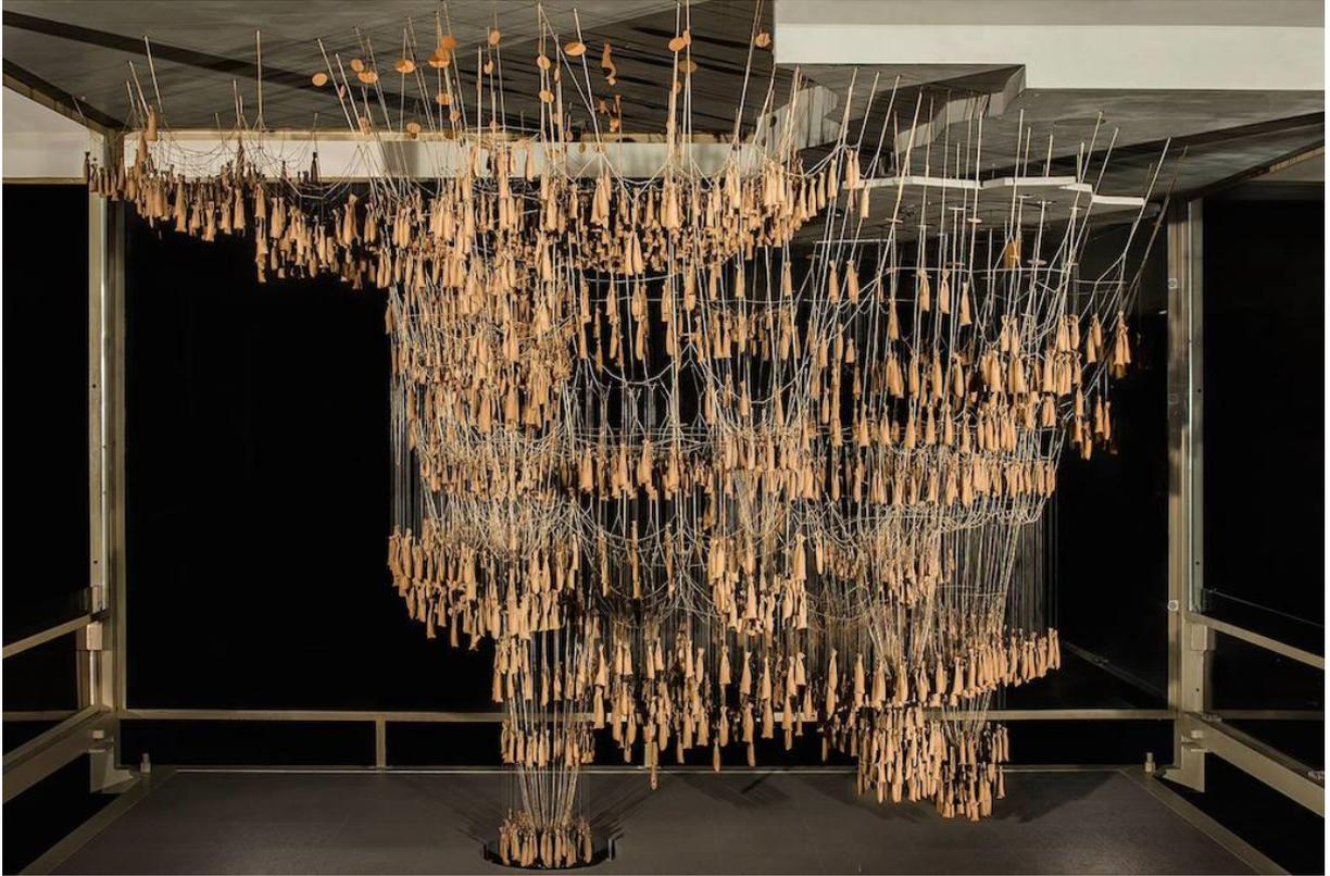
Figura 1.1 Modelo de cordas suspensas de Antoni Gaudí para A Sagrada Família.
