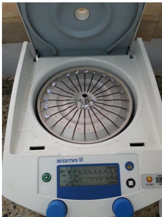
Figura 7: Centrífuga para micro-hematócrito.
