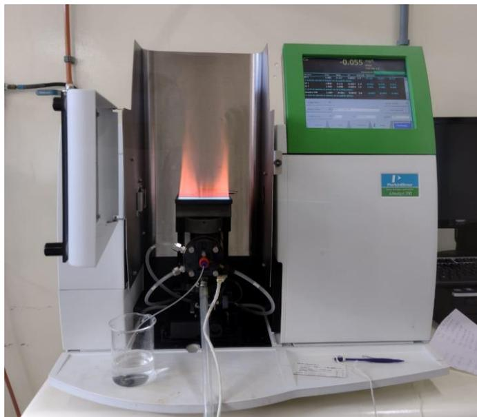
Figura 10: Espectrofotômetro de absorção atômica com chama.
