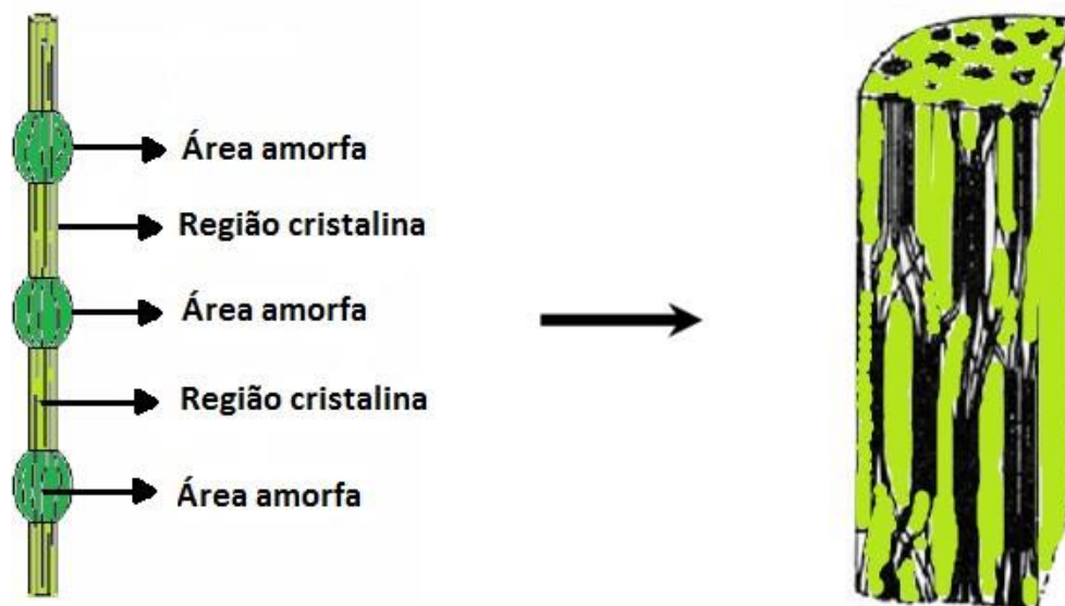
Figura 5 - Representação das regiões amorfa e cristalina da fibra de celulose. Adaptado de Vilches, 2002.
