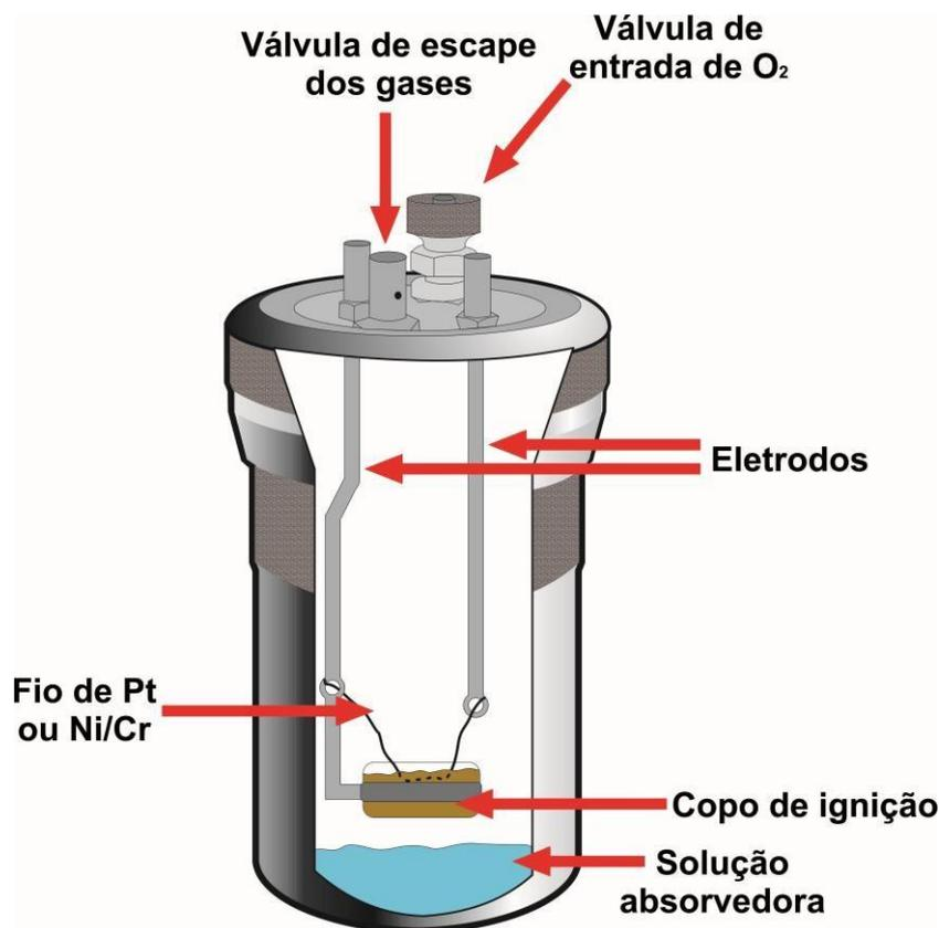
**Figura 2** - Bomba de combustão de aço utilizada na decomposição de amostras.
