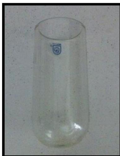
**Figura 6** - Tubo no formato cilíndrico (100 ml) utilizado na centrifugação das amostras.
