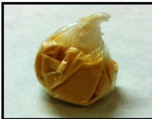
**Figura 10** - Invólucro contendo 350 mg de ovo integral desidratado e 100  $\mu\text{l}$   $\text{NH}_4\text{NO}_3$  ( $6 \text{ mol l}^{-1}$ ).
