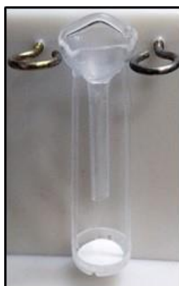
Figura 4. Dispositivo de quartzo utilizado na MIC como suporte para as amostras.
